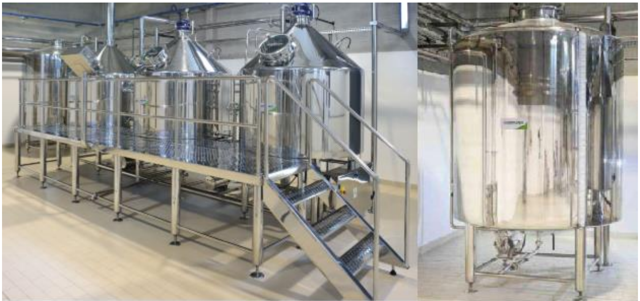
Figura 33 - A direita um sistema tribloco de sala de brassagem, a esquerda uma caldeira/tanque de água quente Fonte: Catalogo Serra Inox (2019) 121
