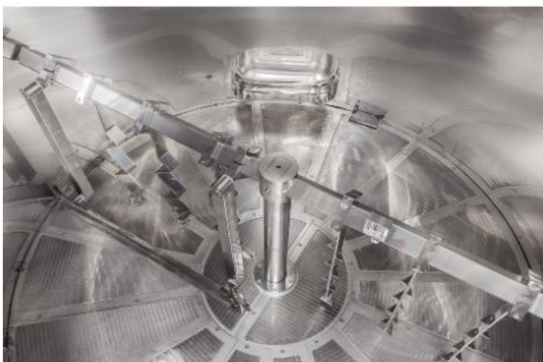
Figura 34 - Visão interna de uma tina de filtração. Fonte: Catalogo Serra Inox (2019) 121
