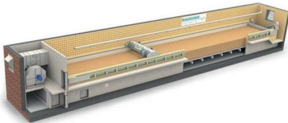
Figura 9 – Reator de germinação para malte Saladin . Fonte: imagem retirada do site da Rauscher (2019) 87
