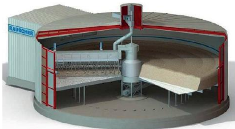
Figura 10 – Reator circular de germinação para malte. Fonte: imagem retirada do site da Rauscher (2019) 87
