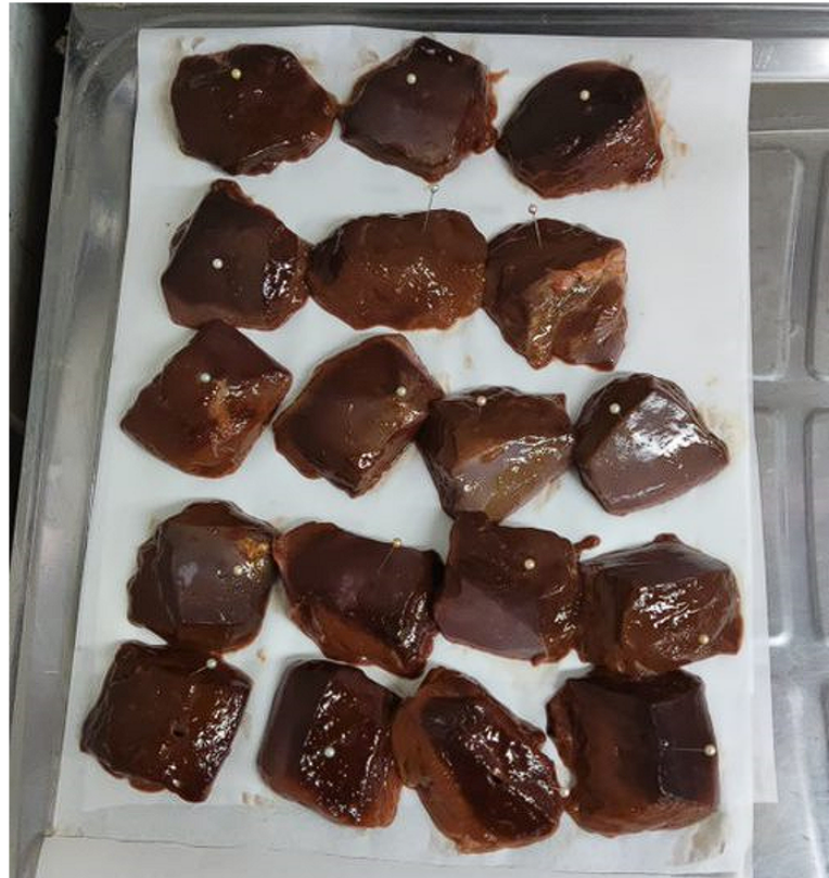
Figura 43 – Padronização de amostras para teste ex-vivo de ablação com fígado bovino e o equipamento ARFACTA. .
