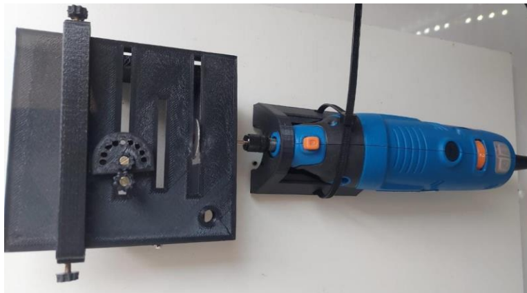
Figura 9 - Motor e disco usados para corte e divisão da amostra
