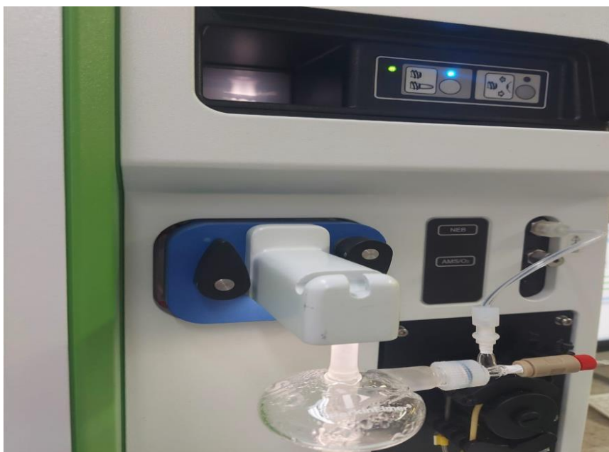
Figura 6 – Câmara de nebulização do ICP-MS
