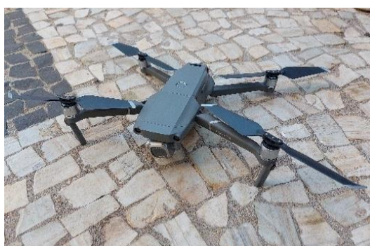
Figura 4.6 – RPA utilizada no levantamento fotográfico.
