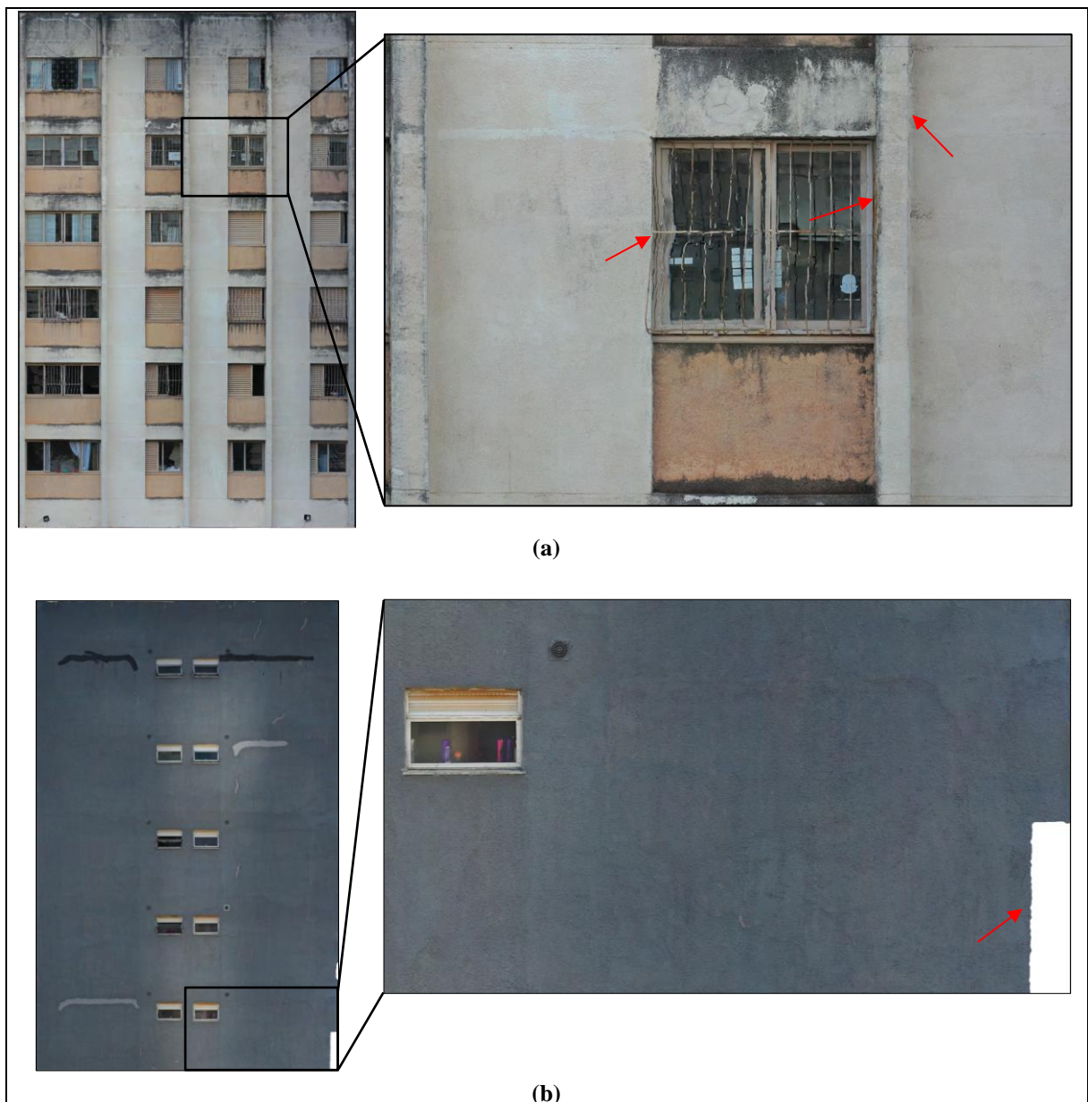
Figura 5.6 – Exemplos de falhas nos ortomosaicos obtidos por processamento digital de imagens: (a) Amostra A1.6; (b) Amostra A3.2.
