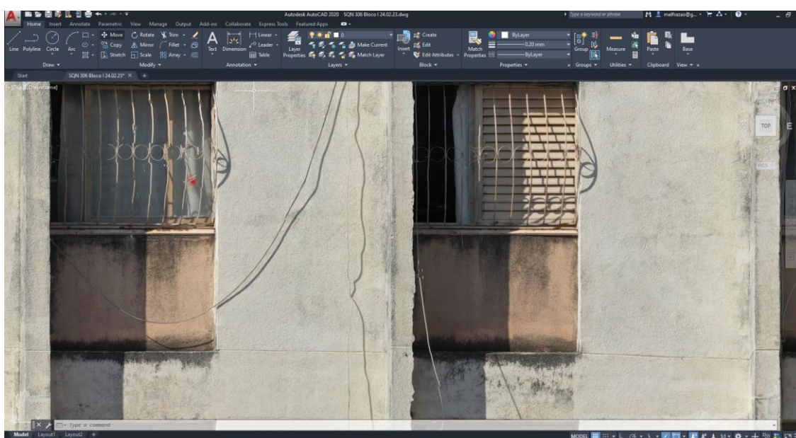
Figura 4.11 – Aproximação definida para a identificação de anomalias (altura de um pavimento e largura correspondente).
