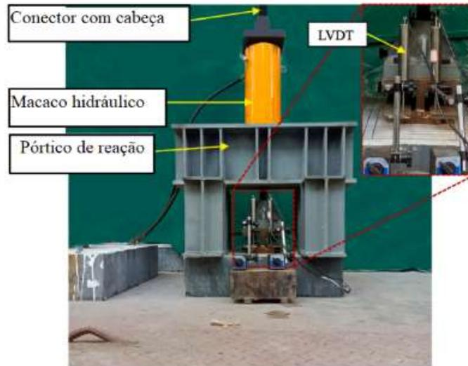
Figura 2.19 - Sistema de ensaio. Fonte: Adaptado de Lai *et al.* (2023).
