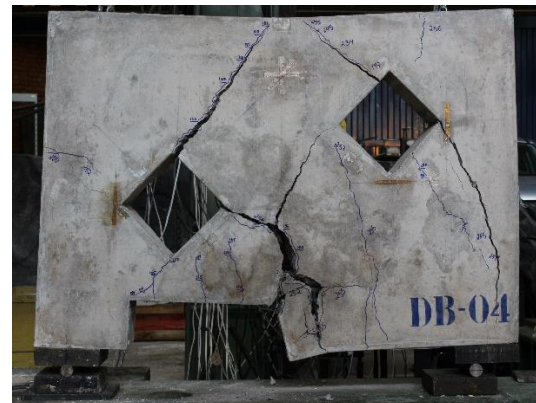
Figura 4.11 – Modo ruptura DB1-W-H2-U-2
