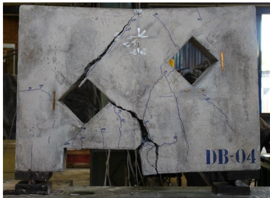
Figura 4.10 – Modo ruptura DB1-W-H2-U-1
