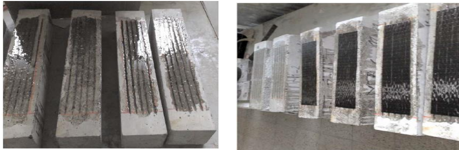
(a) Aplicação da resina nas aberturas
