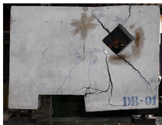
Figura 4.5 – Modo de ruptura DB1-H1-U-2
