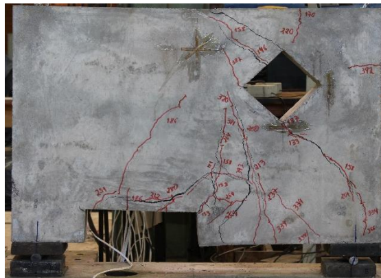
Figura 4.23 – Modo ruptura DB3-W-H1-U-1
