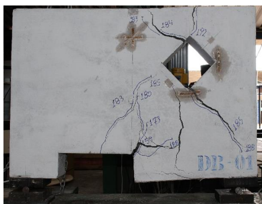
Figura 4.4 – Modo de ruptura DB1-H1-U-1
