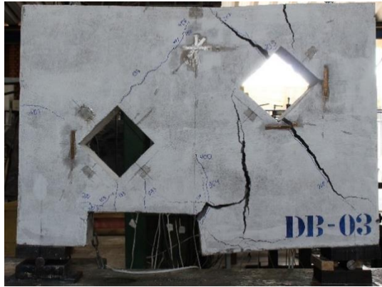
Figura 4.8 – Modo de ruptura DB1-H2-U-1
