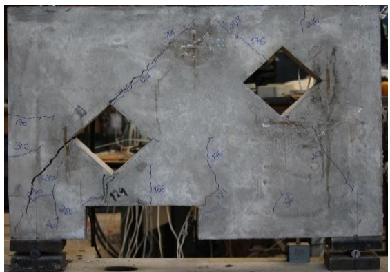
Figura 4.21 – Modo ruptura DB2-W-H2-U-A-1
