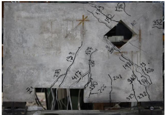
Figura 4.17 – Modo ruptura DB2-W-H1-U-A-1
