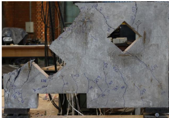
Figura 4.19 – Modo de ruptura DB2-H2-U-A-1
