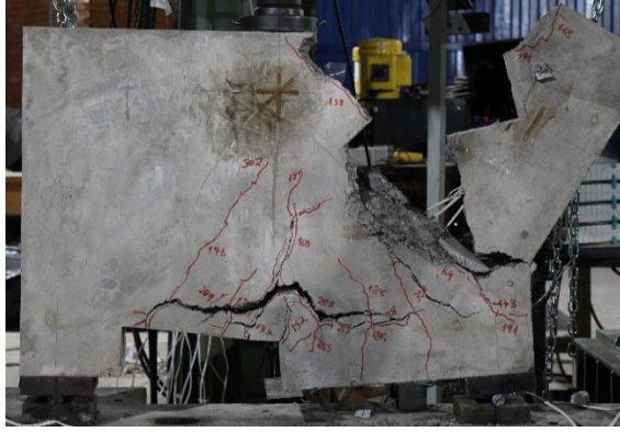
Figura 4.15 – Modo de ruptura DB2-H1-U-A-1
