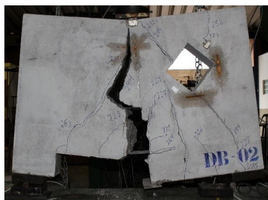
Figura 4.7 – Modo ruptura DB1-W-H1-U-2
