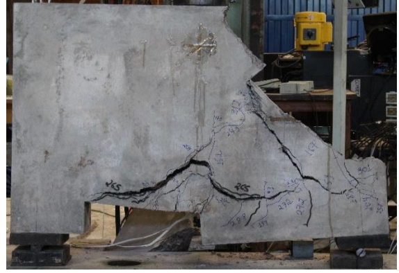
Figura 4.16 – Modo de ruptura DB2-H1-U-A-2
