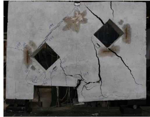
Figura 4.9 – Modo de ruptura DB1-H2-U-2
