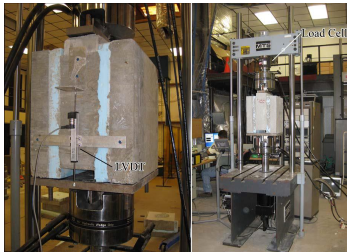
Figura 14 – Configuração do ensaio push-out (NAITO et al. , 2012).
