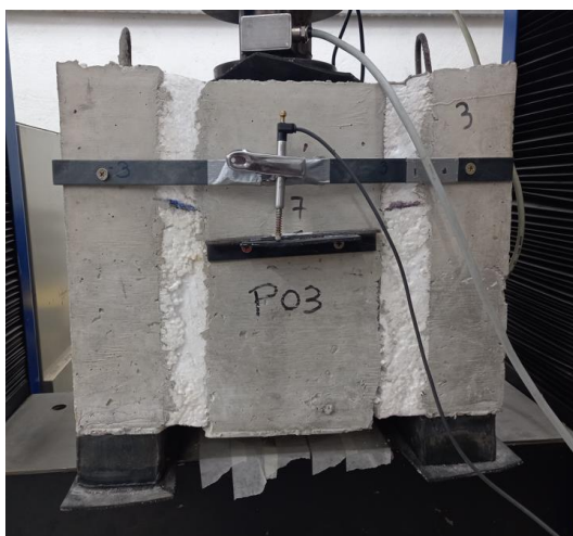
Figure 49 – Espécime do painel sanduíche após ensaio push-out .
