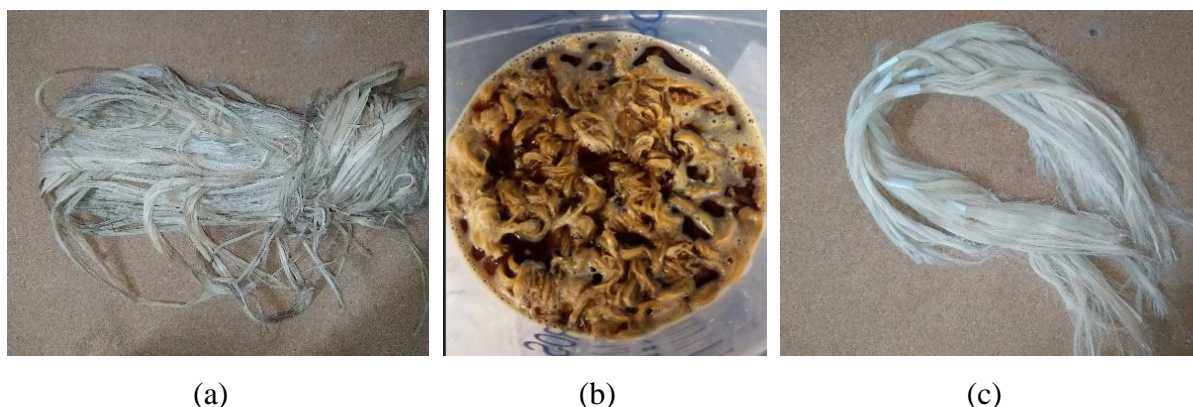
Figura 25 - Fibra de curauá: (a) in natura ; (b) processo de tratamento; (c) fibra penteada.
