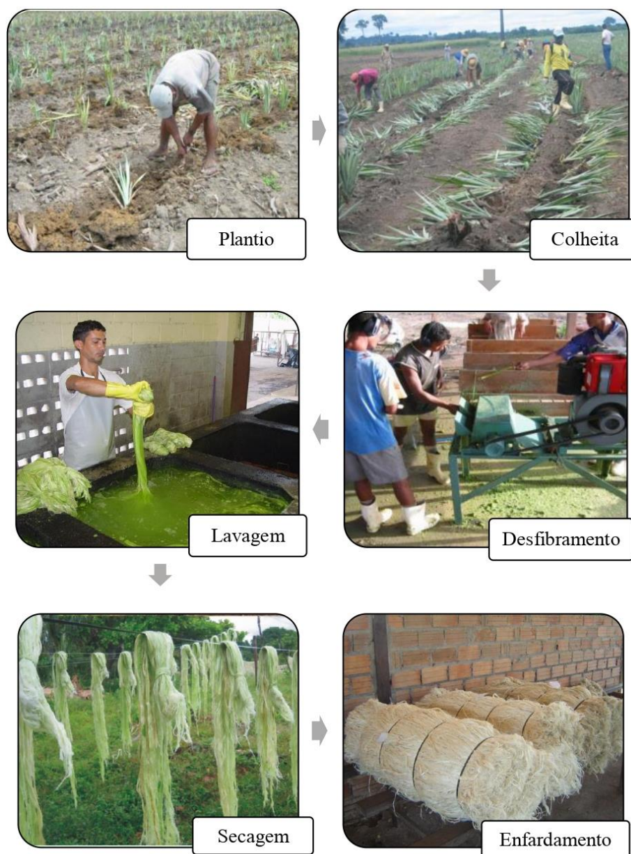
Figura 23 – Processo de produção da fibra de curauá (SILVA, 2011).
