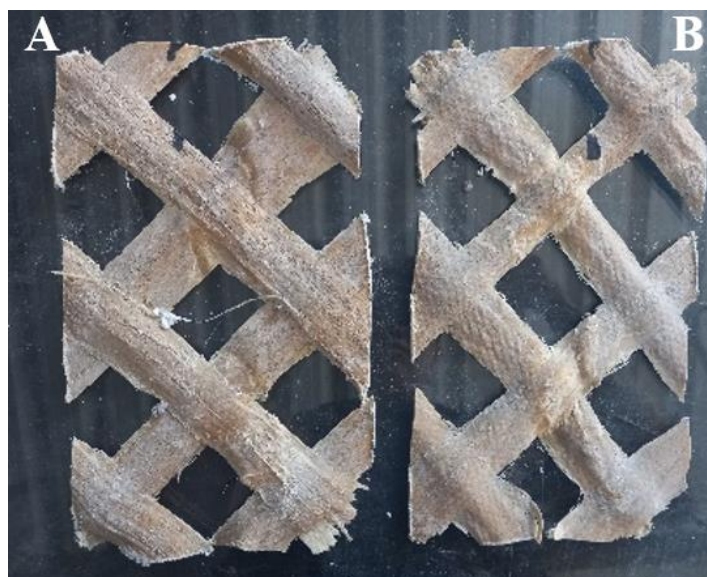
Figura 47 – Conectores de matriz poliuretana do óleo da mamona extraídos dos blocos de concreto após ensaio push-out : (a) CONC-CCOM 01; (b) CONC-CCOM 02; (c) CONC-CCOM 03.
