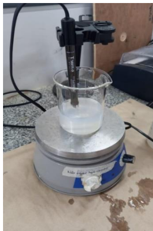
Figura 36 – pHmetro utilizado para verificação do pH das amostras de NS e NSF
