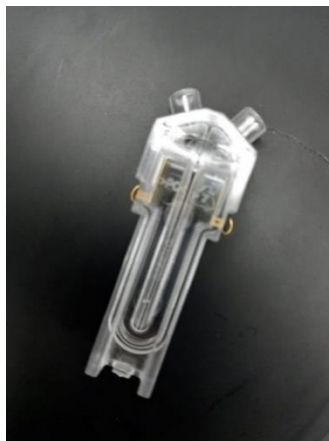
Figura 32 - Célula tipo DTS1060C
