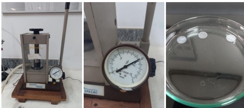
Figura 34 – Prensa Hidráulica Manual utilizada para obtenção da pastilha
