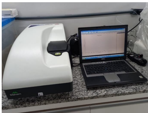
Figura 31 - Equipamento Zetasizer Nano Series acoplado a um computador
