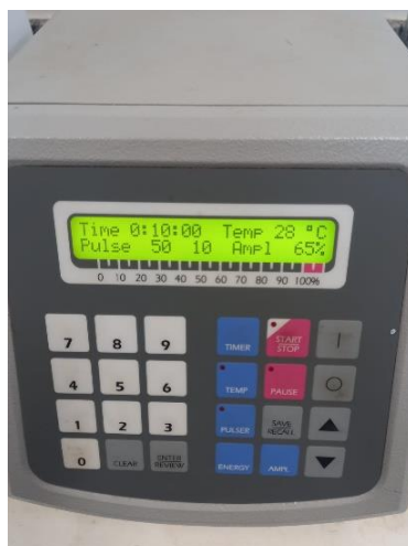
Figura 27 - Parâmetros do Processo de Sonicação
