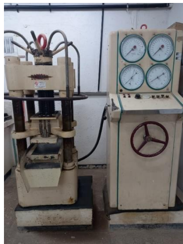
Figura 42 – Prensa Denison utilizada para rompimento dos corpos de prova
