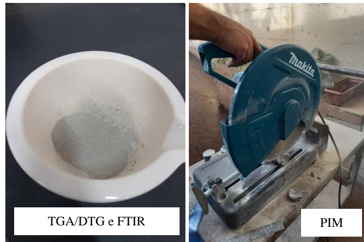
Figura 44 – Preparação das amostras para os ensaios microestruturais
