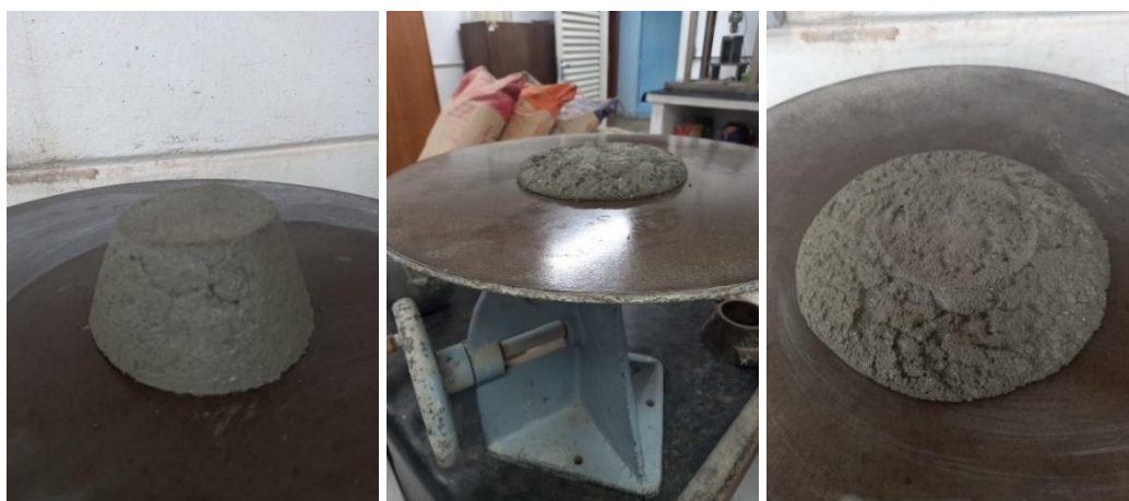
Figura 46 - Ensaio da mesa de consistência para verificação do espalhamento das argamassas
