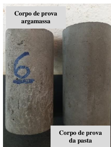
Figura 59 – Aspecto das superfícies dos corpos de prova das amostras de argamassa e de pasta
