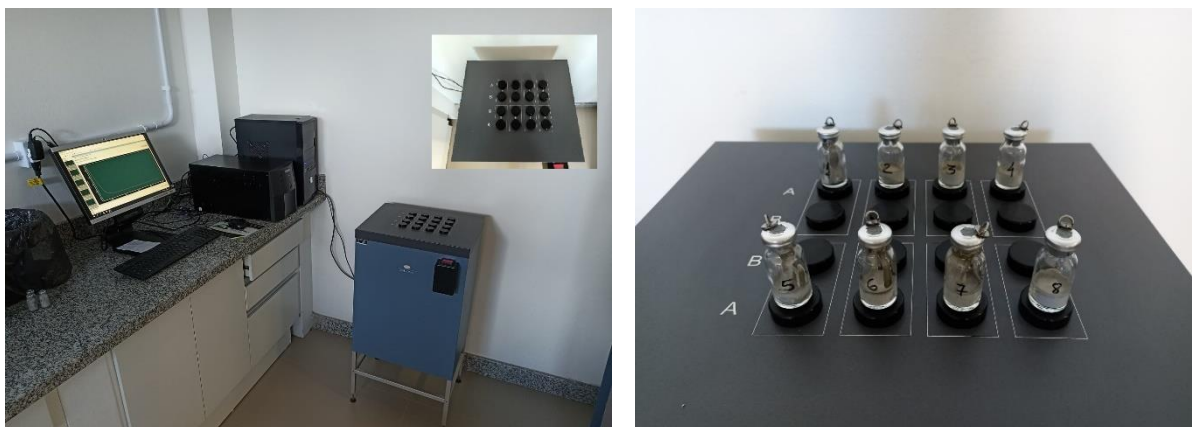
Figura 47 - Calorímetro de condução isotérmica Thermometric AB da TAM Air
