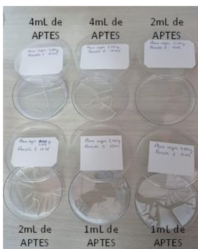
Figura 28 – Procedimento para secagem das amostras de NSF
