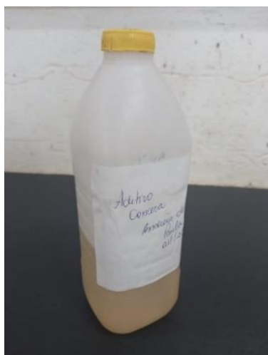
Figura 18 - Aditivo superplastificante (SP) Tipo 2 – CONCERA SA8225
