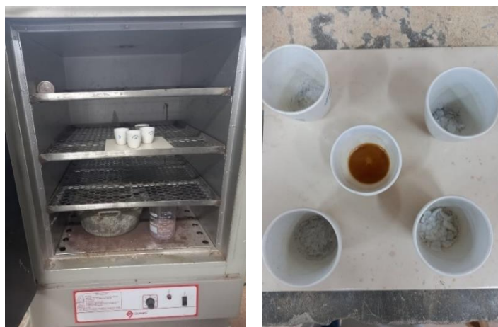
Figura 35 – Amostras de NS, NSF e aditivo superplastificante (SP) secas em estufa
