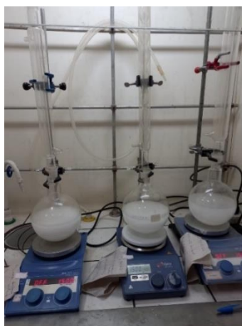
Figura 24 - Agitação magnética do sistema reacional por 24 horas.
