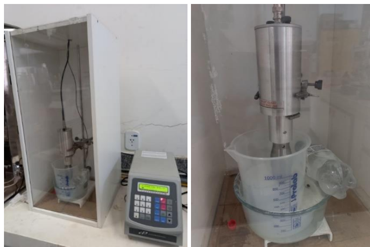
Figura 26 - Processo de ultrassonificação da NSF's.
