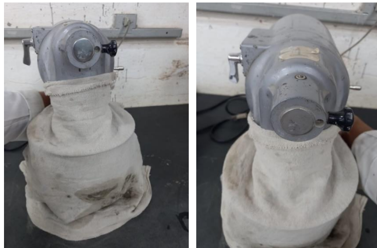
Figura 39 – Preparação das argamassas no misturador planetário
