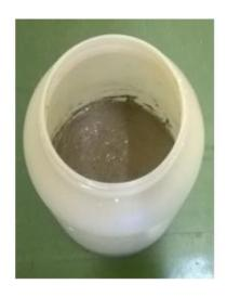
Figura 4.2 - Rejeito em forma de polpa retirado da Mina Stava (Bella, 2017)
