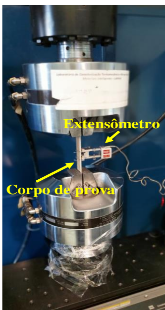
Figura 5. Configuração experimental de análise de fluência.
