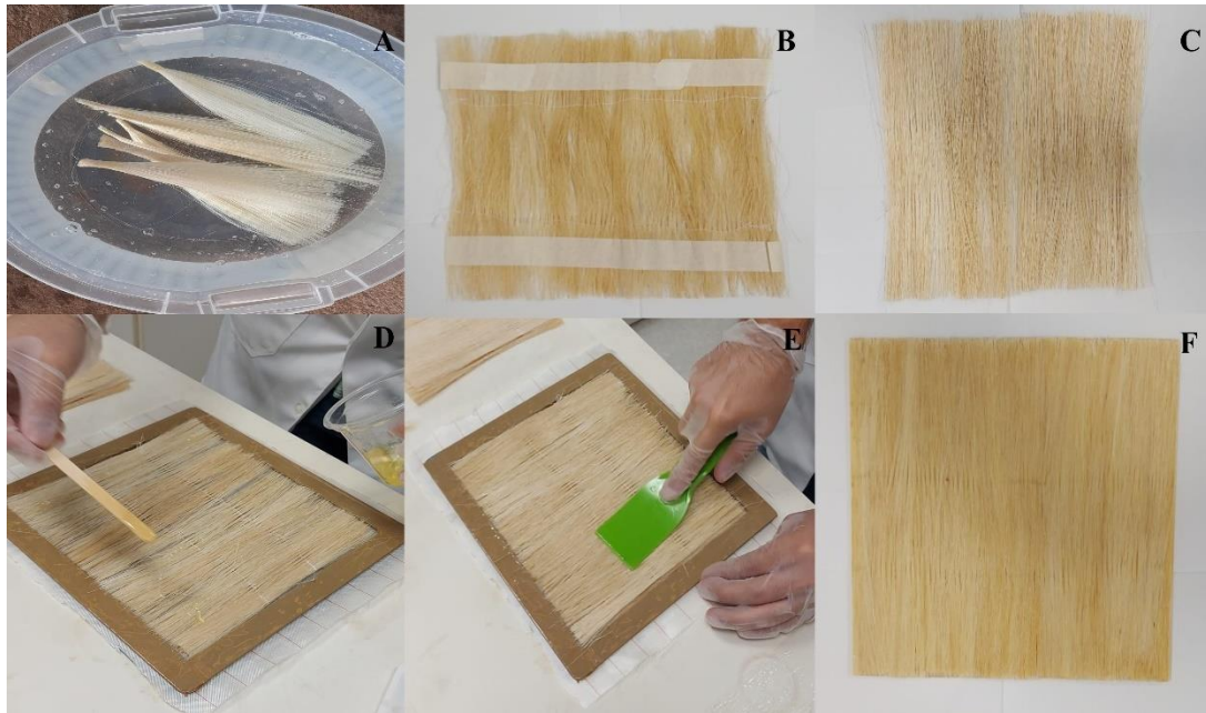
Figura 4. A) Fibras penteadas; B) Manta selada com fita; C) Fibras costuradas; D) Aplicação de resina sobre as fibras unidirecionais; E) Impregnação da resina sobre as fibras; F) Compósitos finalizado.
