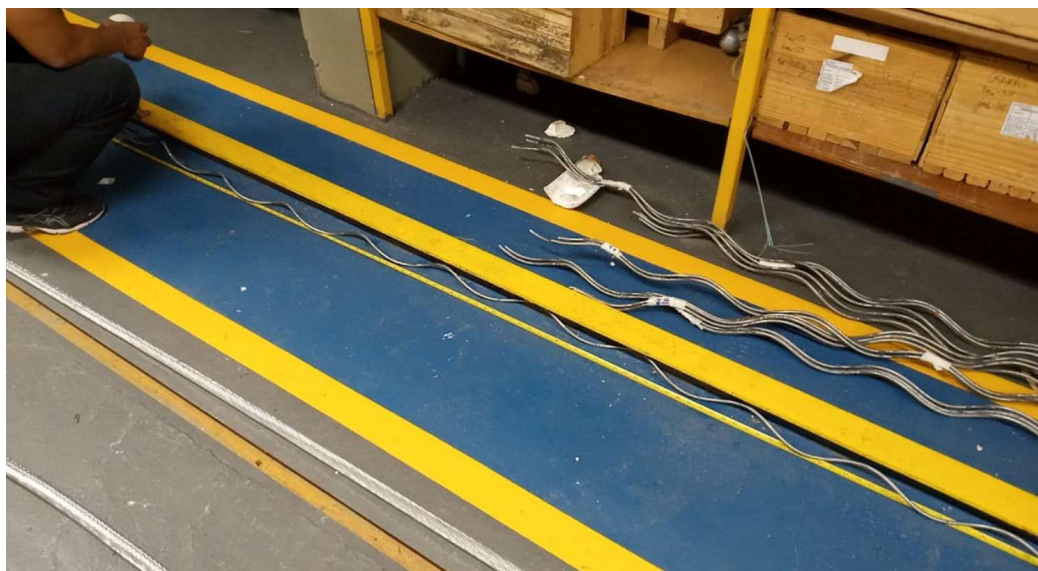
Figura 3.3 – Foto das varetas da emenda em estudo no laboratório de Fadiga de Cabos da UnB (Fonte: Autoria Própria, 2021)
