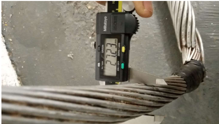
Figura 3.2 – Foto de um conjunto cabo-emenda fornecida para estudo e medida do diâmetro do cabo (Fonte: Autoria Própria, 2021)
