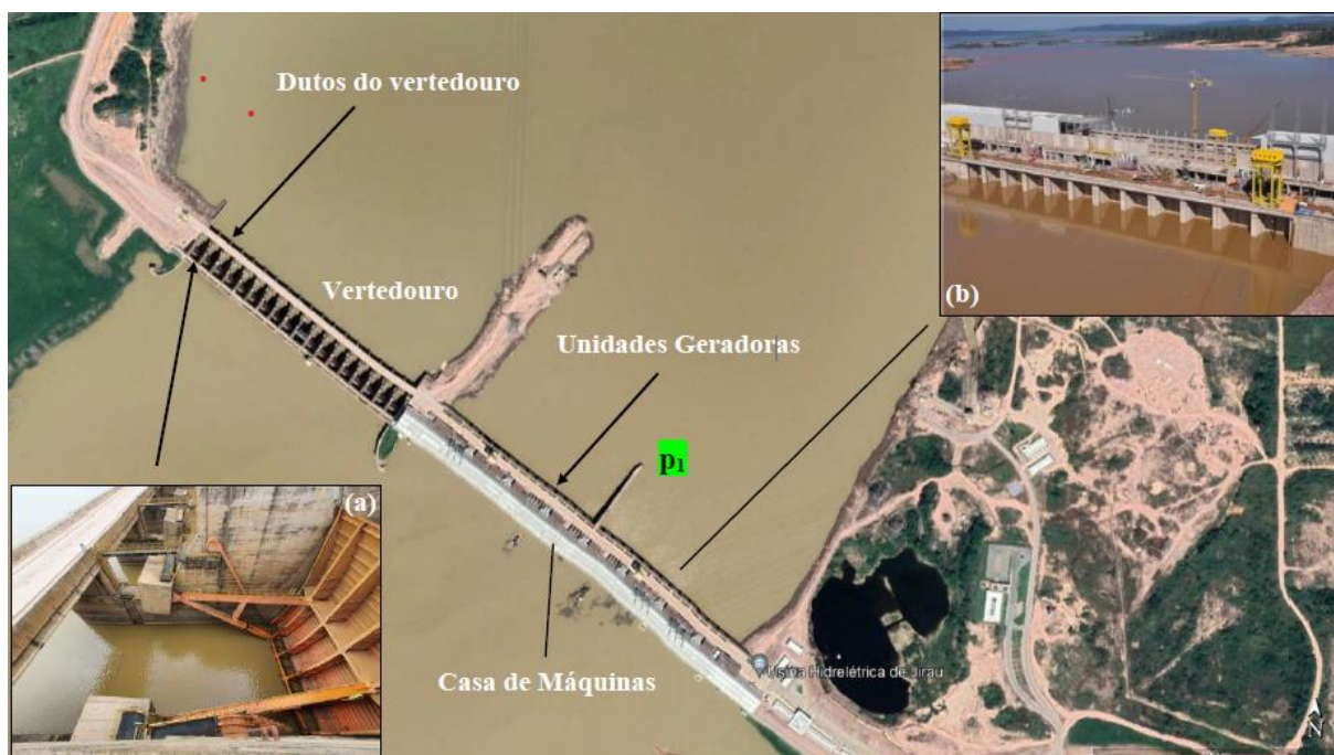
Figura 4.1 – Estrutura das áreas de estudo da UHE Jirau (Fonte: Google Earth) com destaque da (a) Vista vão 18 do vertedouro, com comporta fechada a montante, impedindo o fluxo de água através da abertura a jusante (Fonte: Autores), e da (b) Vista frontal dos tubos de sucção (Fonte: ESBR, 2021).
