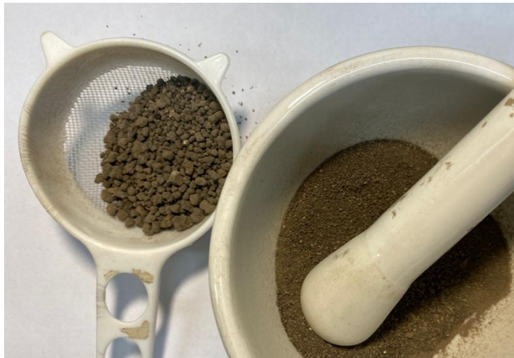
Figura 6: Almofariz, pistilo e peneira comercial utilizados no processamento do talco de turfa.
