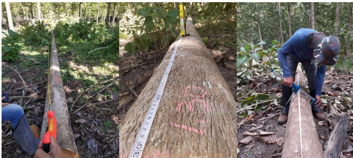
Figura 8. Procedimento de cubagem em plantios clonais de teca no município de Capitão Poço, estado do Pará, Amazônia Oriental, Brasil. Fonte: Santos (2021).
