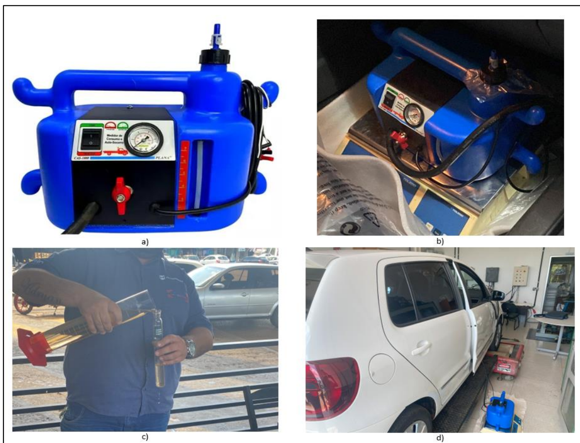
Figura 3.5 Etapas e procedimentos adotados para determinar o consumo de combustível com uso de um tanque externo
