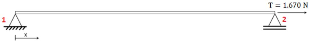
Figura 5.4 – Esquemático do cabo condutor representado por uma viga bi - apoiada sob força de tensionamento axial. Fonte: Modificado de (SILVA, 2022).
