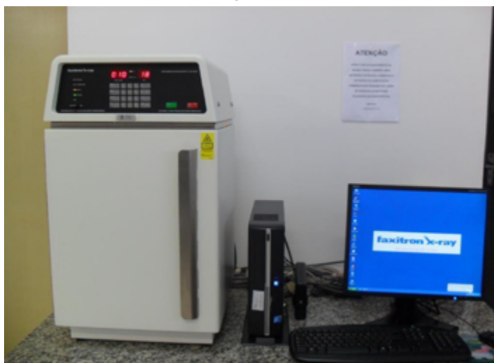
Figura 2: Equipamento digital Faxitron x-ray no laboratório de análise de imagem da ESALQ/USP
