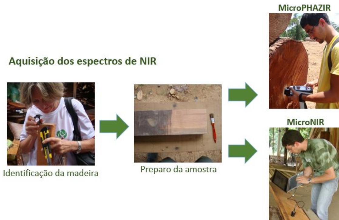
Figura 11. Esquema geral do processo de aquisição dos espectros NIR para amostras da madeira mogno.
