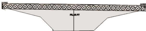
Figura 1 – Configuração do pilar original do viaduto do Eixo Rodoviário (DF002) sobre a Galeria dos Estados, em Brasília (Adaptado pela autora). Fonte: ( https://www.eiradoarq.com/artigos/galeria-dos-estados/ ). Acesso em: jun. 2020).
