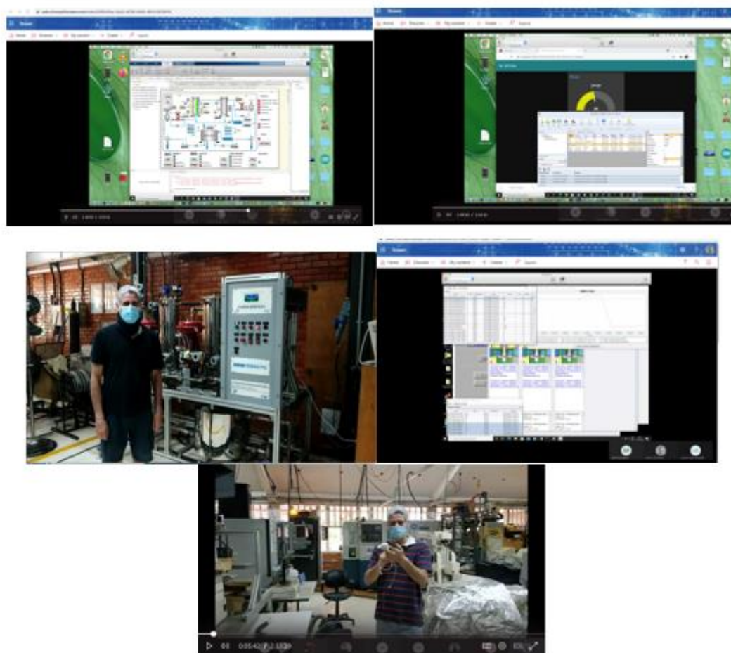
Figura 9 – Aulas de Laboratório Remoto Automação de Processos: Digital Twin Supervisório desenvolvido no MatLab e Digital Twin Dashboard usando Node-Red e PLC Simulado com dados via OPC.
