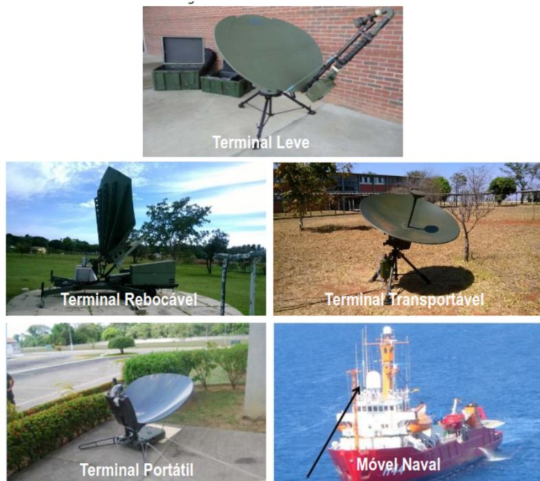
Figura 2.4: Terminais para *link* satelital em utilização pelas Forças Armadas (Fonte: Adaptado de [9])
