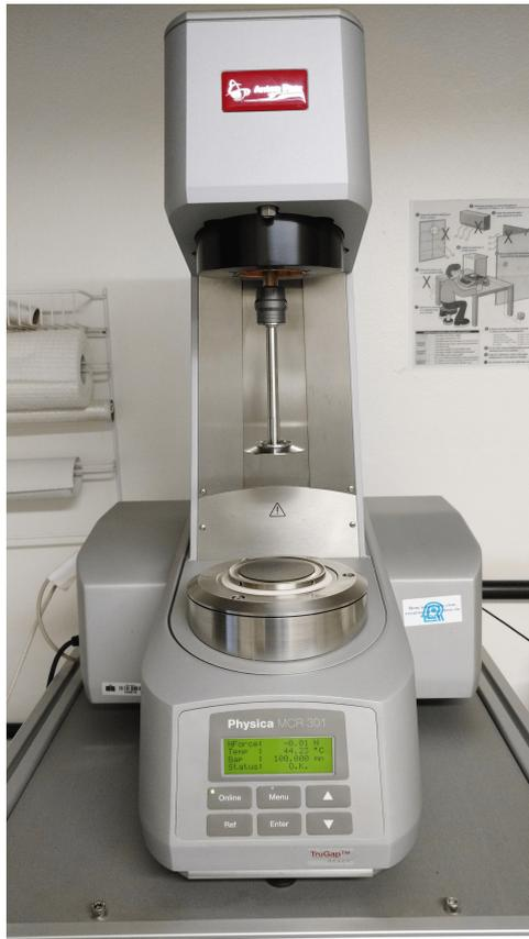
Figura 6.1 – Reómetro Anton Paar-Modelo physica MCR 301.
