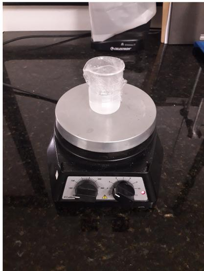
(a) Calentamiento y agitación mecánica de la solución.
