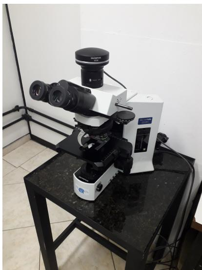
Figura 4.2 – Microscopio Óptico Olympus BX51.
