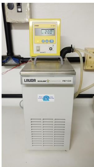
Figura 6.5 – Baño térmico Lauda con control digital de temperatura.
