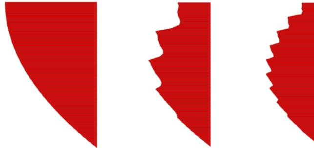
Figura 2.9: Perfil de recalques de um aterro sobre uma camada de fundação rígida – (a) Deslocamentos de fase; (b) Soma de deslocamentos de fases (5 camadas de construção); (c) Soma de deslocamentos de fases (10 camadas de construção).
