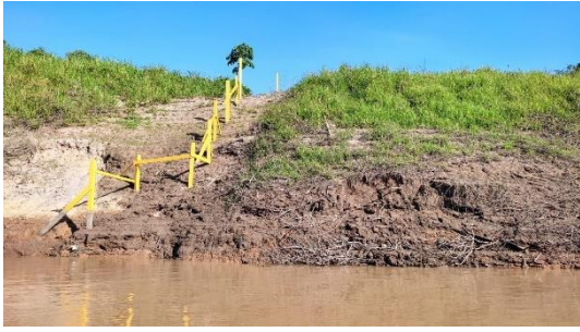
Figura 40 - Régua para amostragem do nível da água no início do período de seca e processos erosivos marginais – Elaborada pelo autor
