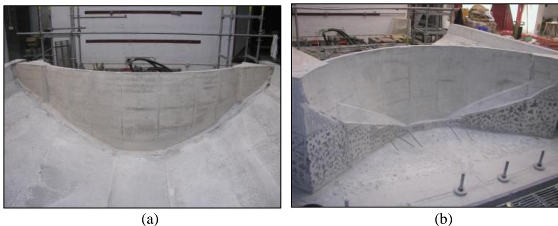
Figura 2.7: Abordagem experimental realizada por Rosca (2008): (a) vista a montante do protótipo da barragem em arco e (b) vista a jusante do protótipo da barragem em arco.
