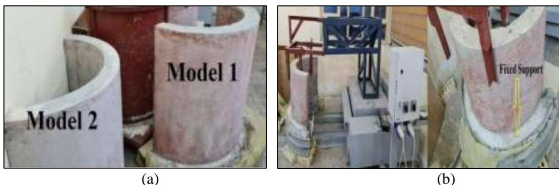
Figura 2.16: Abordagem experimental realizada por Kadhim et al. (2021): (a) modelos de barragem em arco e (b) mesa vibratória para os testes.
