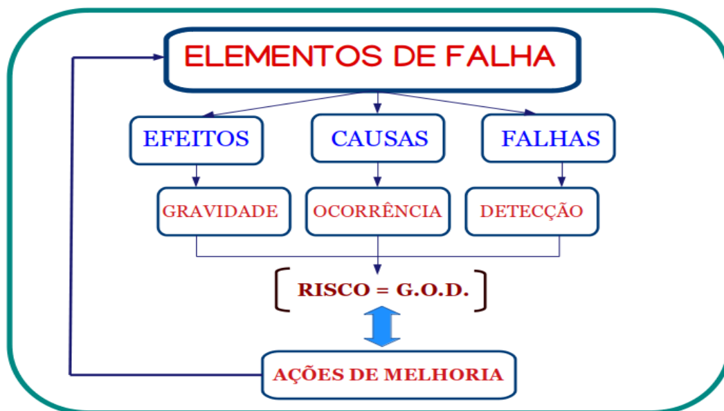
Figura 3.13: Fluxograma de Aplicação da Técnica FMEA aos Riscos do Projeto CCOp Mv
