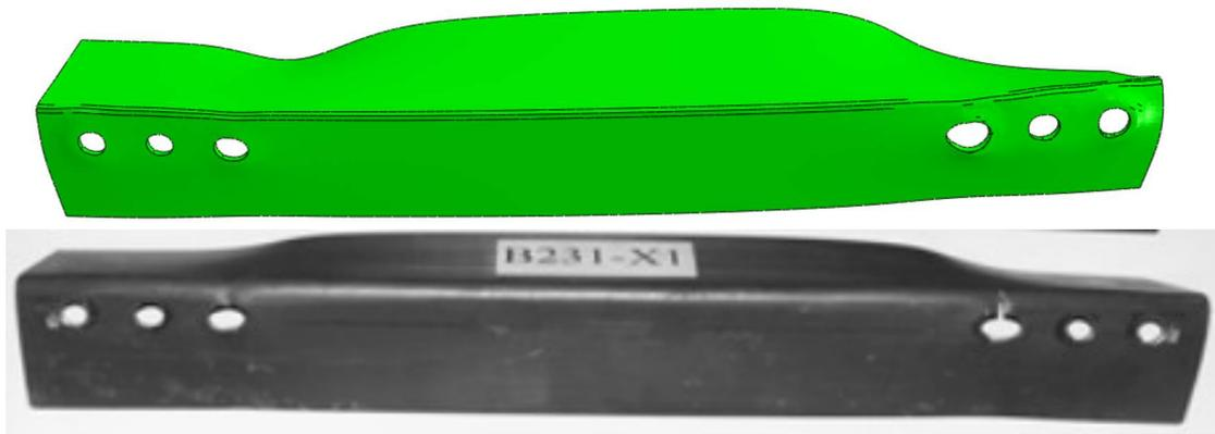
Figura 6.38 – Deformada MEF do modelo B231 X1 e foto do experimental.
