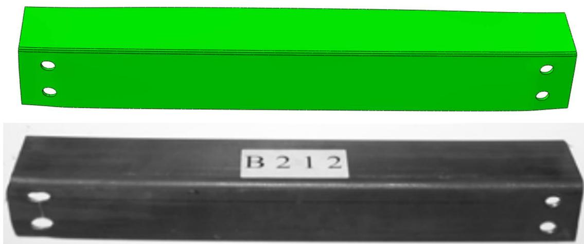
Figura 6.15 – Deformada MEF do modelo B212 e foto do experimental.
