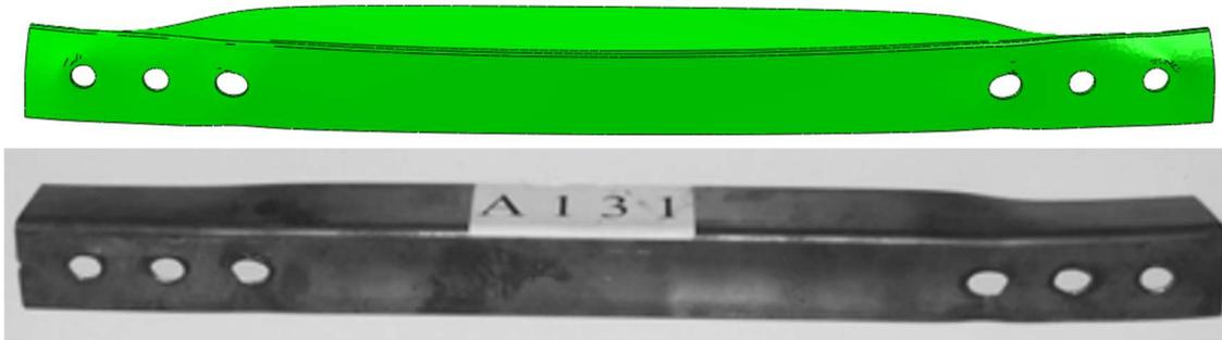
Figura 6.8 – Deformada cantoneira A131 para o modelo numérico e foto do experimental, respectivamente.
