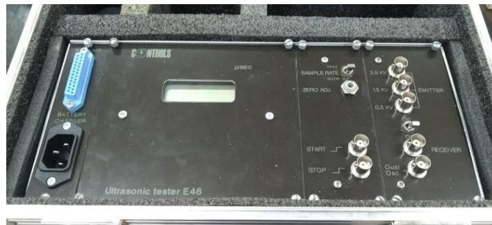
Figura 3.12. Equipamento de ultrassom.
