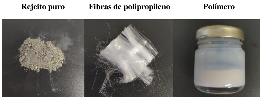
Figura 3.6. Materiais para o compósito rejeito-polímero-fibra (RPF).
