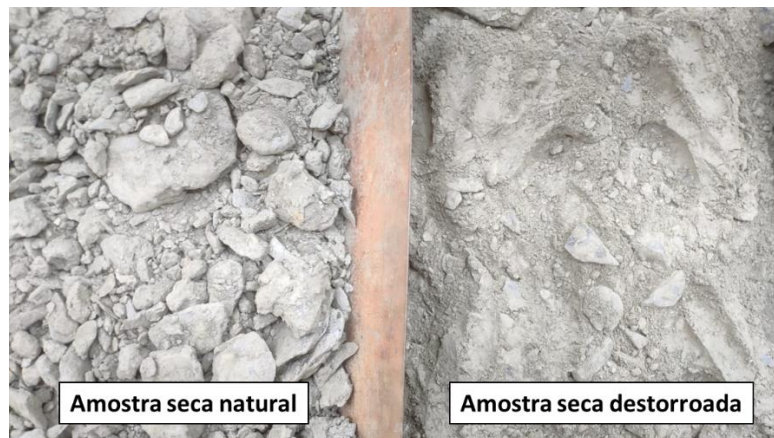
Figura 3.4. Comparação entre amostra seca e destorroada.
