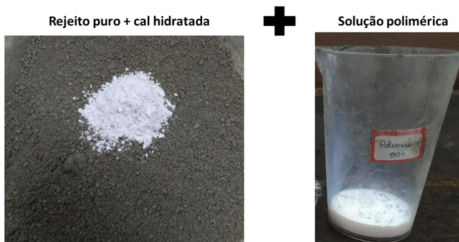
Figura 3.7. Compósitos rejeito-polímero-cal (RPC).
