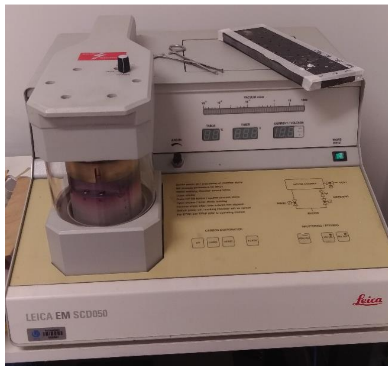
Figura 3.17. Metalização das amostras para MEV.
