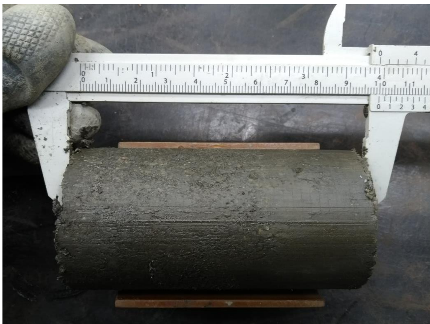
Figura 3.9. Corpo de prova para ensaio de compressão simples.
