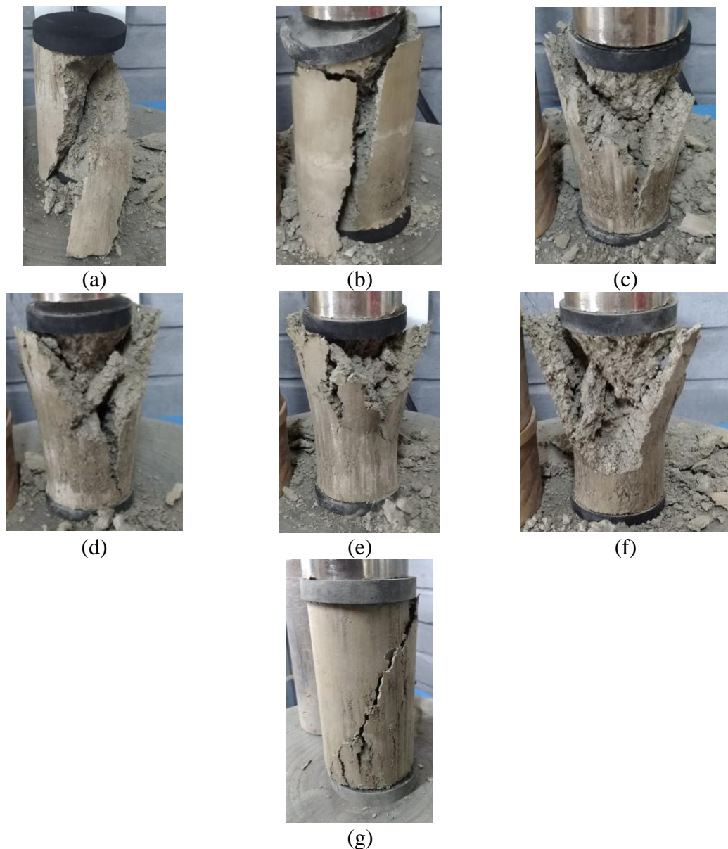
Figura 4.5. Corpos de prova após ensaio de compressão simples. (a) RO; (b) RP_10; (c) RP_20; (d) RP_30; (e) RP_40; (f) RP_50; (g) RP_60.
