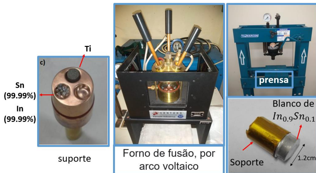
Figura 2.2. 1: Preparação do alvo metálico da liga entre índio/estanho.
