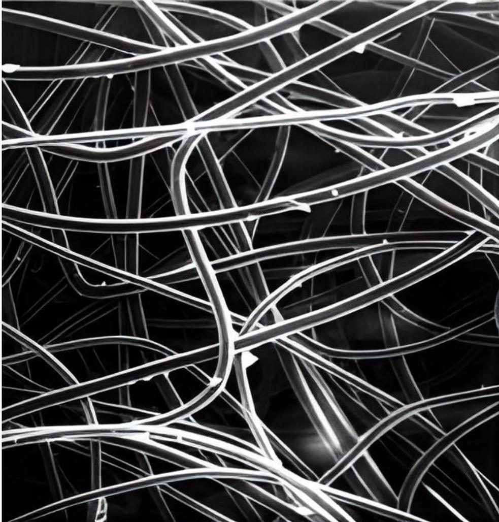
Figura 2.7: Vista microscópica do geotêxtil não tecido do tipo agulhado (Adaptado de MARK *et al.*, 1986).
