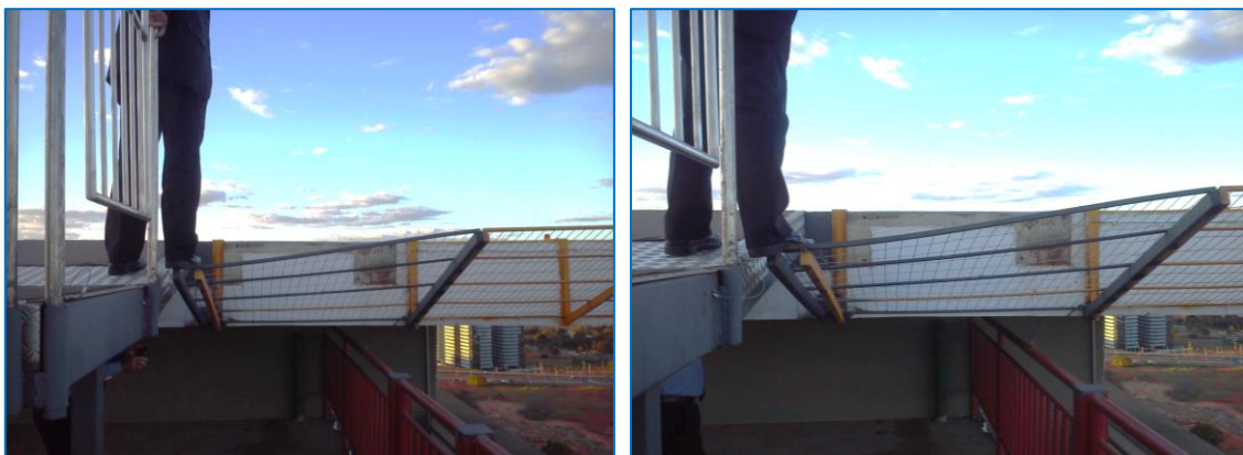
Figuras 44 e 45 – Aplicação de carga na longarina da grade de segurança de heliponto e no reforço durante o 2º ensaio
