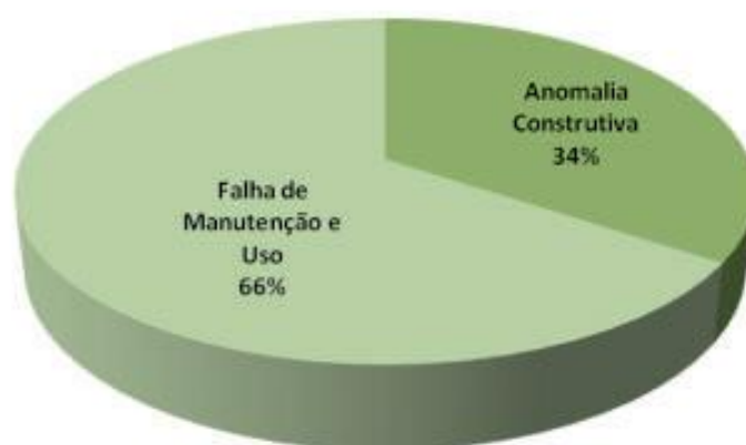
Figura 25 – Distribuição percentual da incidência dos acidentes prediais por tipo de origem. Fonte: IBAPE/SP (2012)
