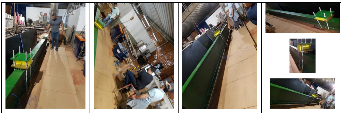
Figura 4.8 - Andamento do ensaio do dia 11/12/2020 com a utilização do sistema de acoplagem para possibilitar os deslocamentos e as aplicações da massa móvel
