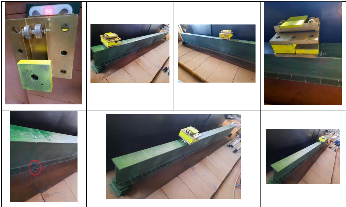
Figura 4.14 - Novas organizações do sistema de massa móvel e dos novos posicionamentos dos acelerômetros – Ensaio dia 29/12/2020
