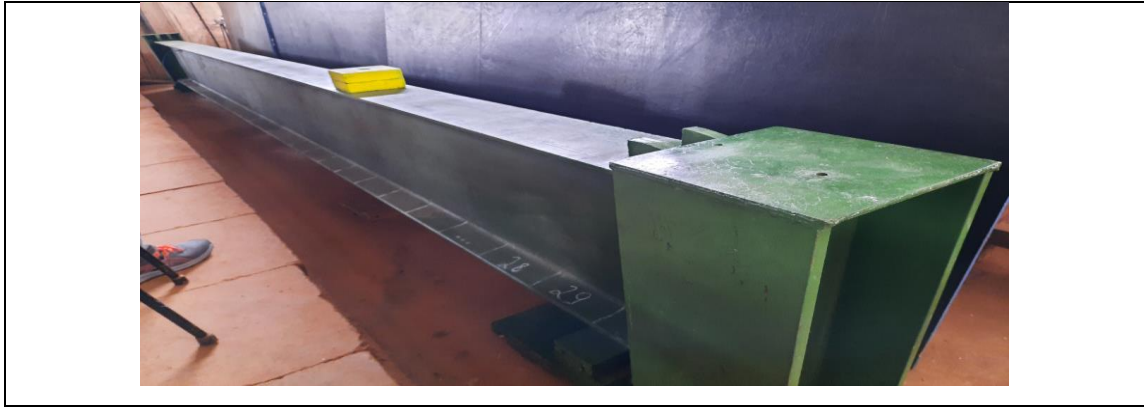
Figura 4.21 - Massa móvel média utilizada – Peso de Cerca de 12,00 kg (Aproximadamente 1,5% do Peso Total da Viga)
