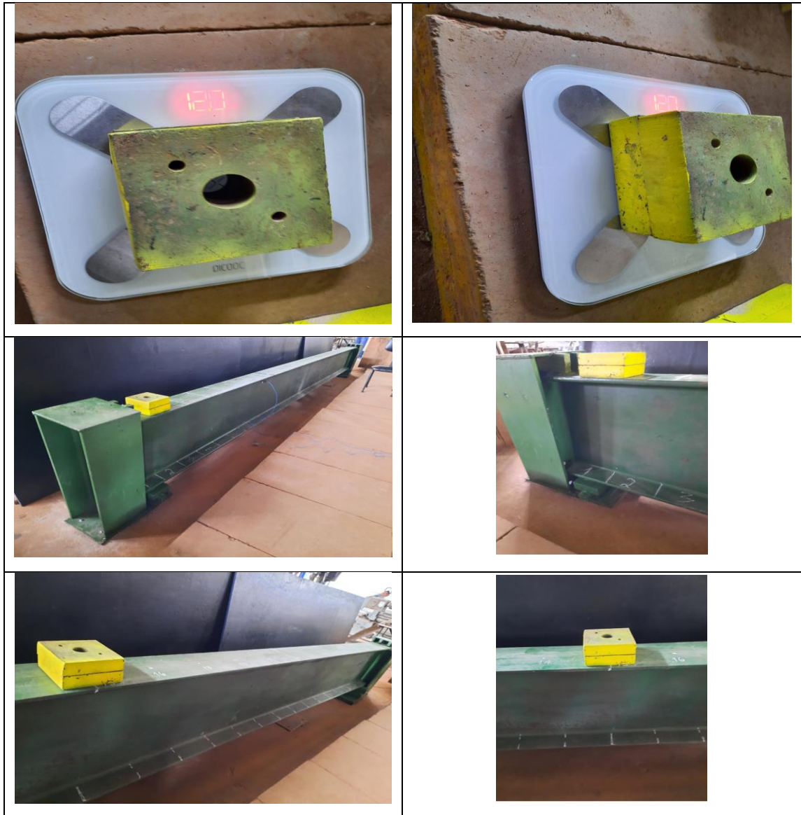
Figura 4.20 - Massa móvel menor utilizada – Peso de Cerca de 6,60 kg (Aproximadamente 0,8% do Peso Total da Viga)
