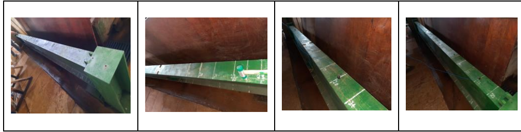
Figura 4.30 - Viga Metálica IPN 500x104 Biapoiada Danificada (6 m) – Ensaio Modal Dia 20/02/2021
