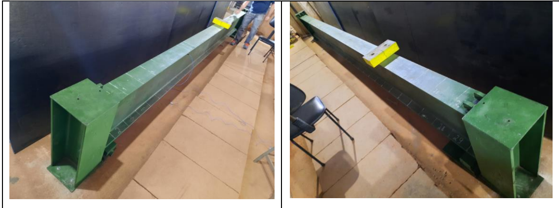
Figura 4.22 - Massa móvel maior utilizada – Peso de Cerca de 27,70 kg (Aproximadamente 3,3% do Peso Total da Viga)
