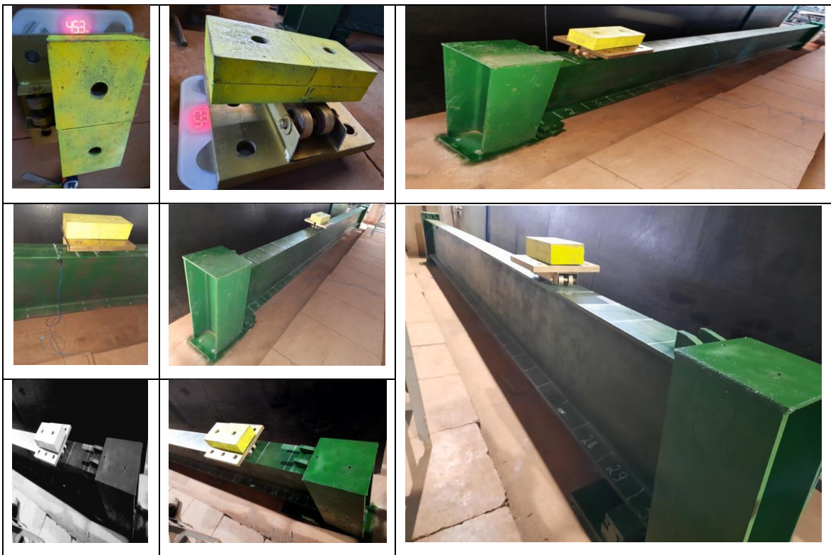
Figura 4.18 - Nova tentativa de organização do sistema de massa móvel e das condições de apoio – Ensaio dia 09/02/2021
