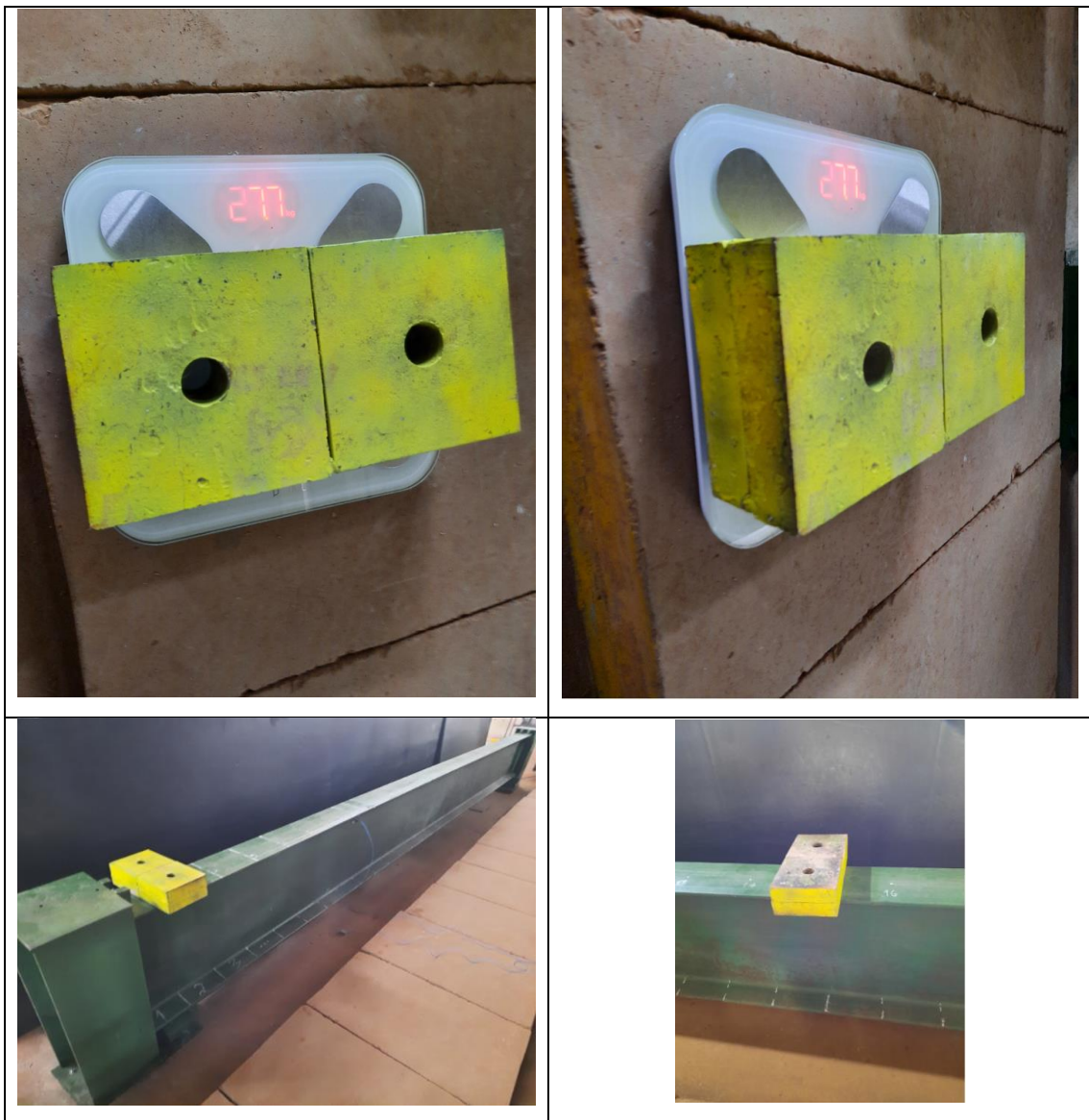
Figura 4.21 - Massa móvel média utilizada – Peso de Cerca de 12,00 kg (Aproximadamente 1,5% do Peso Total da Viga)
