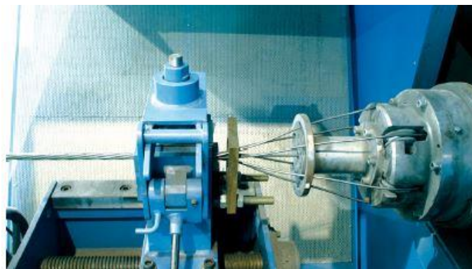
Figura 2.5: Máquina de fabricação de cabos
