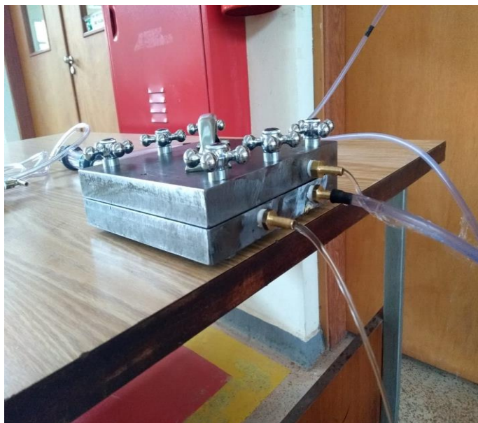
Figura 17. Célula de fluxo com fluxo tangencial ascendente e área de permeação de 4,8 \times 10^{-3} \text{ cm}^2 .
