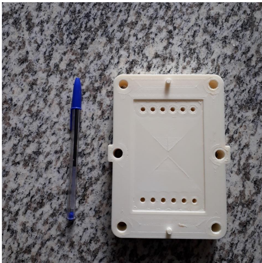
Figura 39 Célula de Fluxo em PLA em impressão 3D sistema de filtração para membranas
