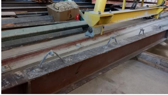
(a) CTs deformados no perfil de aço
