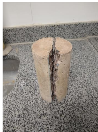
(b) Ensaio de tração por compressão diametral
