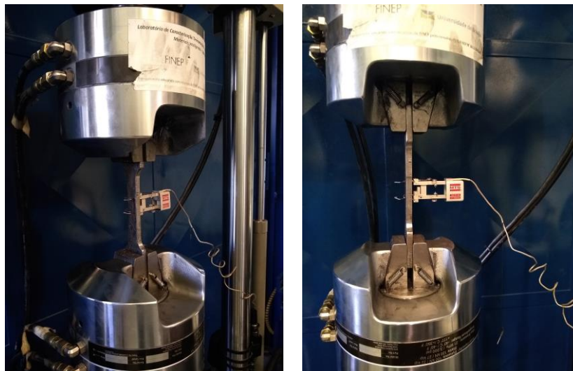
Figura 5.31- Ensaio de caracterização do aço do perfil.
