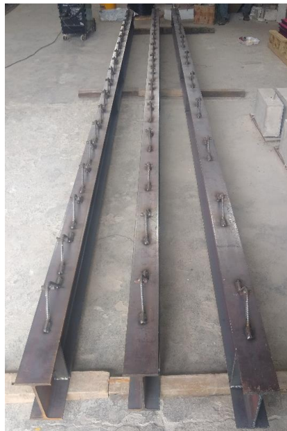
Figura 5.4- Distribuição dos conectores ao longo dos modelos (Unidade: mm).
