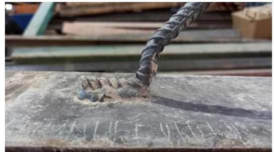
(d) Haste com intabilidade por compressão
