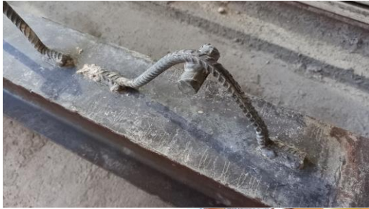
(a) CTs deformados no perfil de aço
