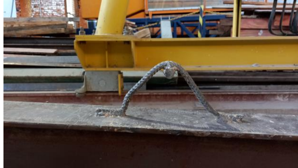
(b) Detalhes da deformada dos CTs
