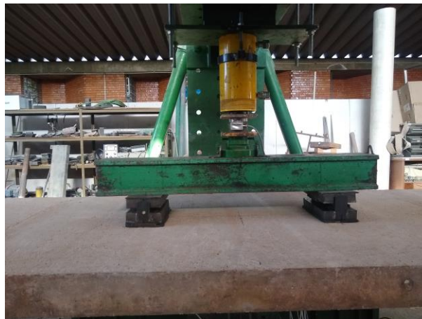
Figura 5.16- Viga rígida de distribuição do carregamento.
