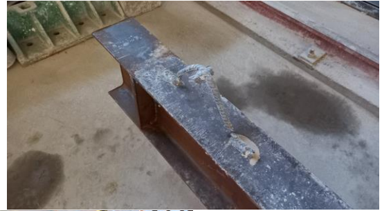
(a) CTs deformados no perfil de aço
