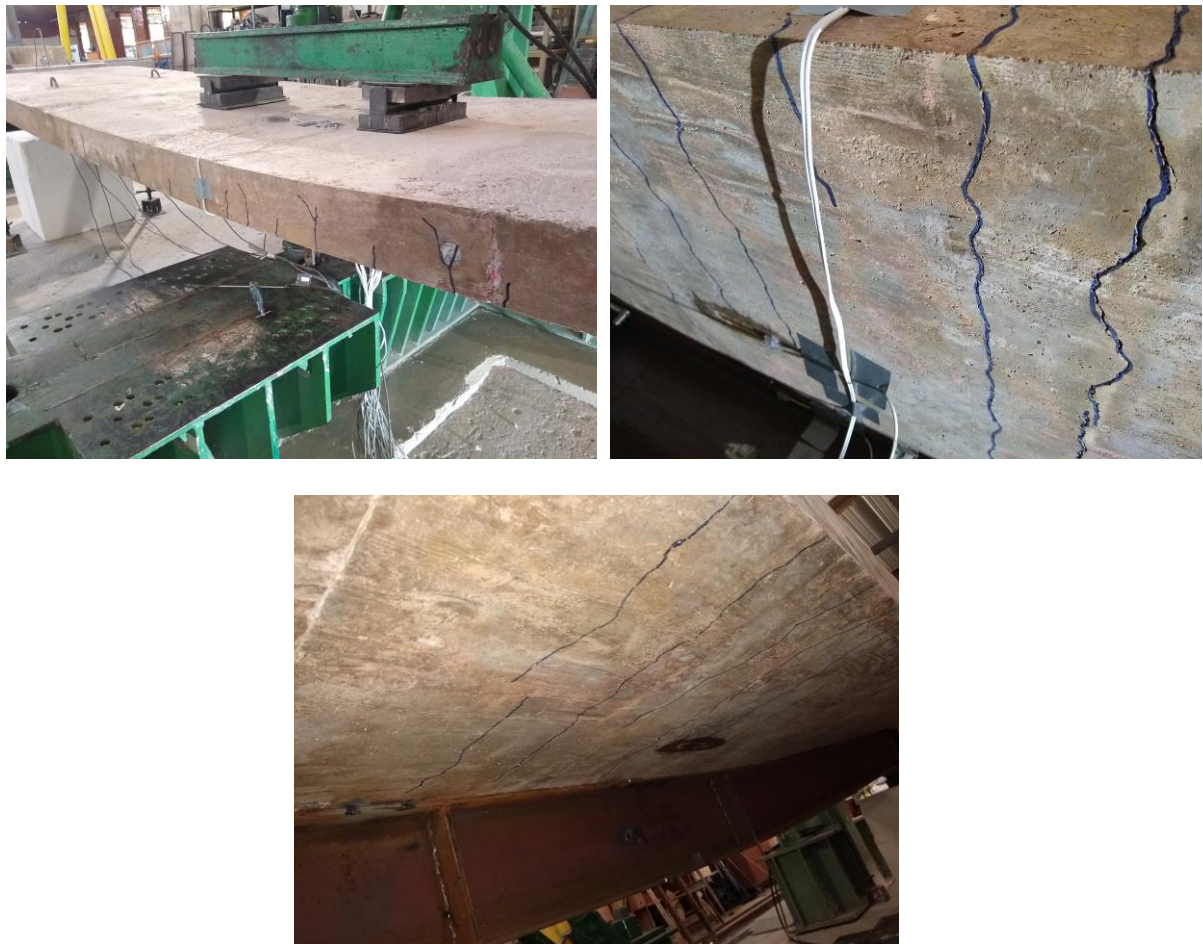
Figura 6.7- Caminho de propagação das fissuras no modelo VCT-01.
