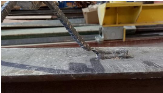
(c) Haste com falha por tração e detalhe da solda
