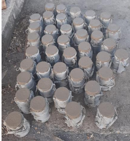
Figura 5.10- Corpos de prova concretados.
