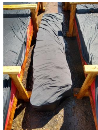
(b) Corpos de prova de concreto cobertos com tecido encharcado
