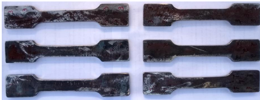
Figura 5.30- Geometria dos corpos de prova do perfil de aço (Unidade: mm).
