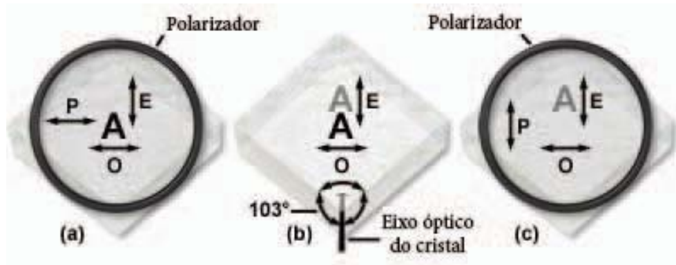
Figura 3.1: Na figura (b) observa-se a imagem dupla enquanto na (a) e (c) é possível observar, com a ajuda de um polarizador, o feixe ordinário e o extraordinário, respectivamente (Olympus®).
