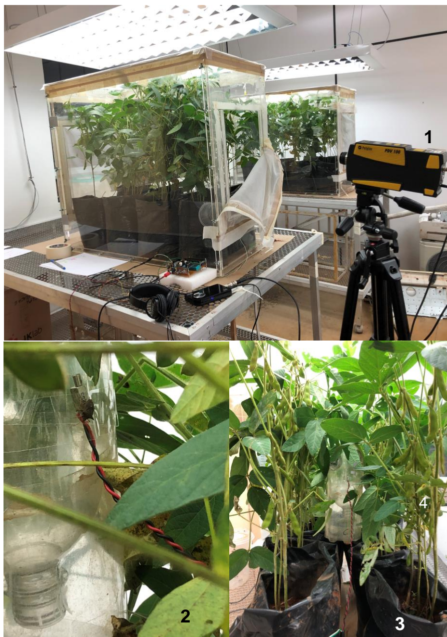
Figura 5.1. Esquema experimental de reprodução de sinais fêmeas de E. heros em armadilhas de plástico em plantas de soja dentro de gaiolas de acrílico. 1- Vibrometro laser. 2- Armadilha de garrafa Pet com excitador mecânico conectado. 3-Armadilha entre as plantas de soja.
