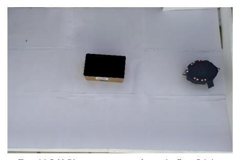
Figura 4.6: Robô físico com caneta presa em furo traseiro. Fonte: Próprio autor.
