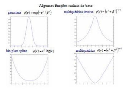
Figura 2.9: RBF-Funções de Base Radial. Fonte: Exemplo MatLab.
