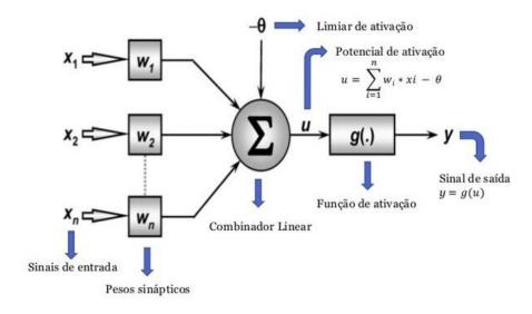
Figura 2.5: Esquema representativo de um neurônio artificial. Fonte: McCulloch & Pitts (1943), adaptado.
