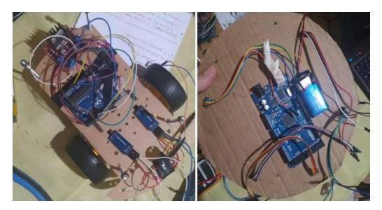
Figura 3.20: Sensor de velocidade LM393 encaixado nos Enconders durante a montagem de uma versão teste do robô. Fonte: Próprio autor.
