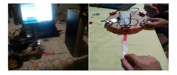
Figura 3.15: Calibração do sensor de distância. Fonte: Próprio autor.
