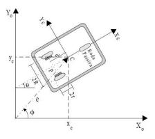
Figura 2.1: Robô móvel de tração diferencial em sistemas de coordenadas retangulares. Fonte: Júnior & Hemerly (2003).
