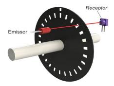
Figura 3.18: Exemplo de funcionamento de Enconder. Fonte: Almeida (2017).
