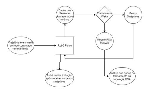
Figura 3.11: Fluxograma da arquitetura geral do sistema. Fonte: Próprio autor.
