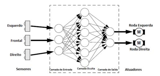
Figura 2.13: Modelo do controle por RNA do robô. Fonte: T. Braünl (2003), adaptado.
