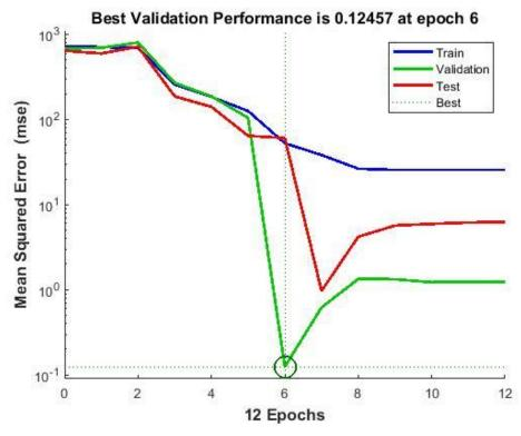
Figura A-15: Resultado do experimento cruz: Erro quadrático médio topologia 5,5,2 . Fonte: Próprio autor.
