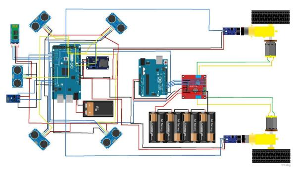
Figura 3.23: Esquemático do robô desenhado no programa Frietzing. Fonte: Próprio Autor.
