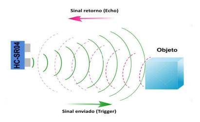
Figura 3.13: Funcionamento do HC-SR04. Fonte: Site Flipflop.
