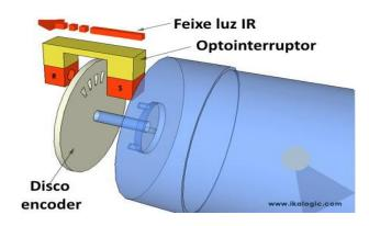
Figura 3.19: Exemplo de funcionamenteo de Enconder. Fonte: Almeida (2017).
