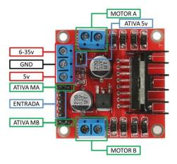
Figura 3.17: Ponte H LN298N. Fonte: Datasheet Ln298N adaptado.
