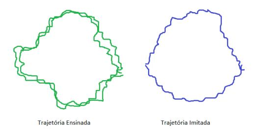
Figura 4.13: Resultado do experimento 2 do robô físico: trajetória ensinada X trajetória imitada. Fonte: Próprio autor.
