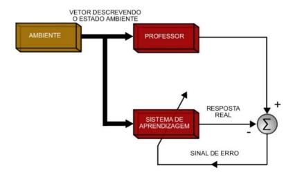
Figura 2.4: Diagrama de blocos da aprendizagem supervisionada. Fonte: HAYKIN (2001), adaptado.
