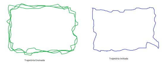
Figura 4.18: Resultado do experimento 3 do robô físico: trajetória ensinada X trajetória imitada. Fonte: Próprio autor.
