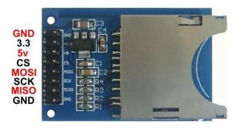
Figura 3.22: Módulo SD.Fonte: Site Baú da Eletônica.
