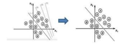
Figura 2.7: Processo de treinamnto perceptron. Fonte: Del Lama (2016).
