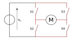
Figura 3.16: Esquemático de uma Ponte H. Fonte: BUTTAY (2006).
