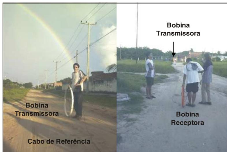
bobina receptora, ambas posicionadas em modo Dipolo Horizontal.
