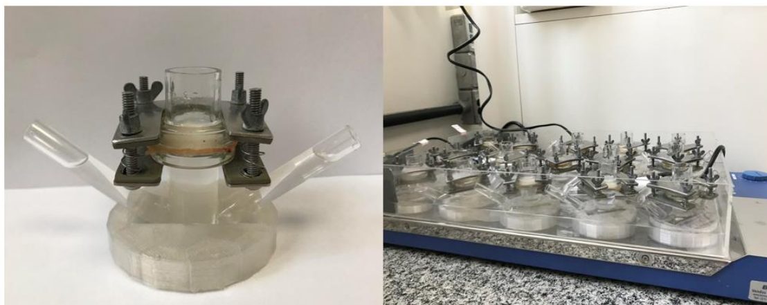
Figura 16: Células de difusão modificada do tipo Franz a pele de orelha de porco separando o compartimento doador do receptor para realização do ensaio in vitro de penetração cutânea em banho aquecido com termostato.
