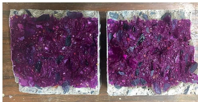
Figura 3.7 - Corpos de prova rompidos após exposição a CO 2 na câmara de carbonatação e com aspersão de fenolftaleína como indicador
