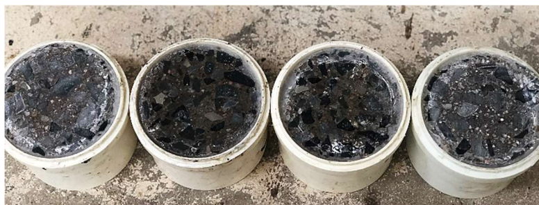
Figura 3.8 - Vedação das bordas do corpo de prova com o aparato para o ensaio de migração de cloretos
