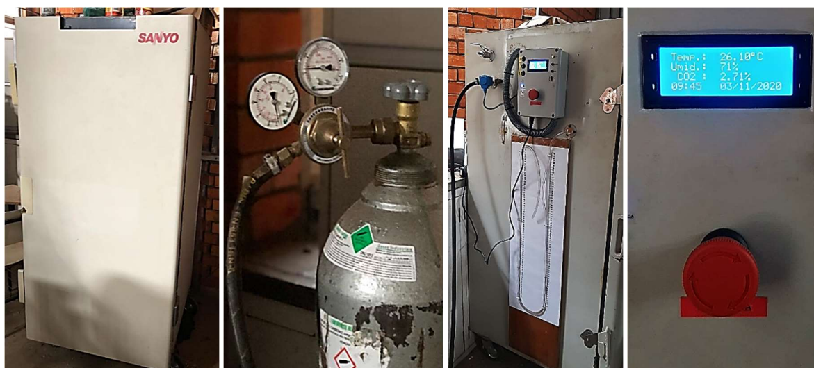
Figura 3.5 - Câmara de carbonatação acelerada para ensaio
