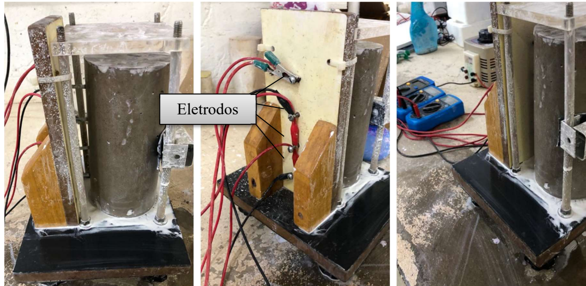
Figura 3.4 - Ensaio de resistividade superficial em andamento
