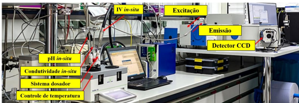
Figura 13: Combinação da técnica ILACS com medida in-situ de pH e condutividade.
