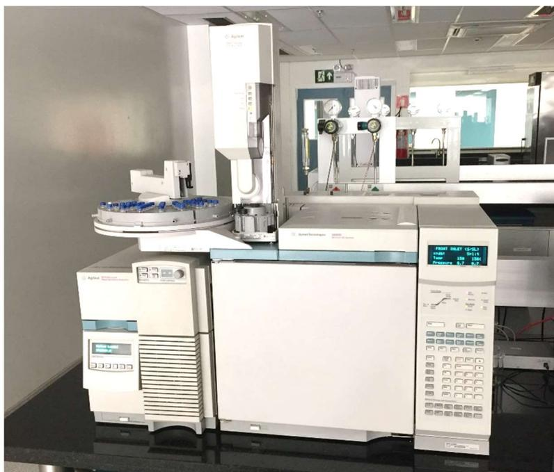
Figura 28: Sistema GC-MS Agilent® modelo 6890N/5973N com amostrador automático.
