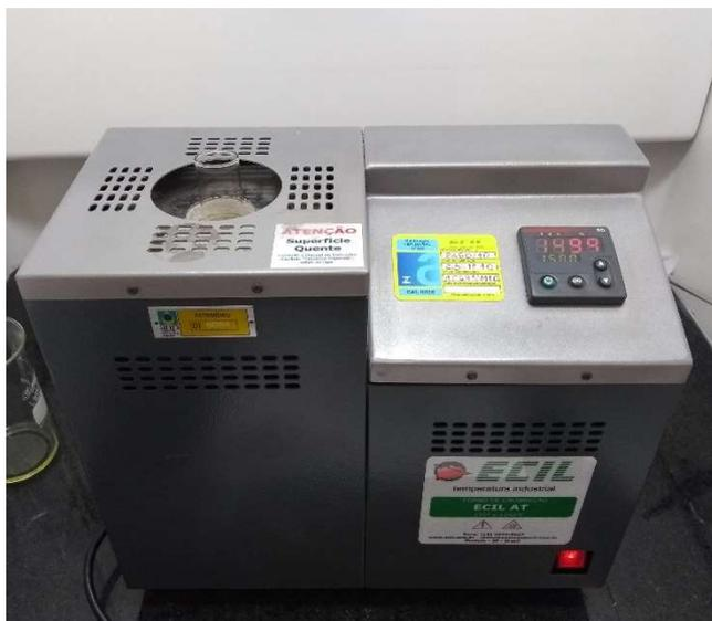
Figura 24: Forno utilizado para realização do ensaio de estabilidade em alta temperatura com tubo de ensaio e amostra.
