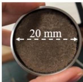
Figura 3.6. Corpo de prova utilizado para realização do ensaio de sucção.
