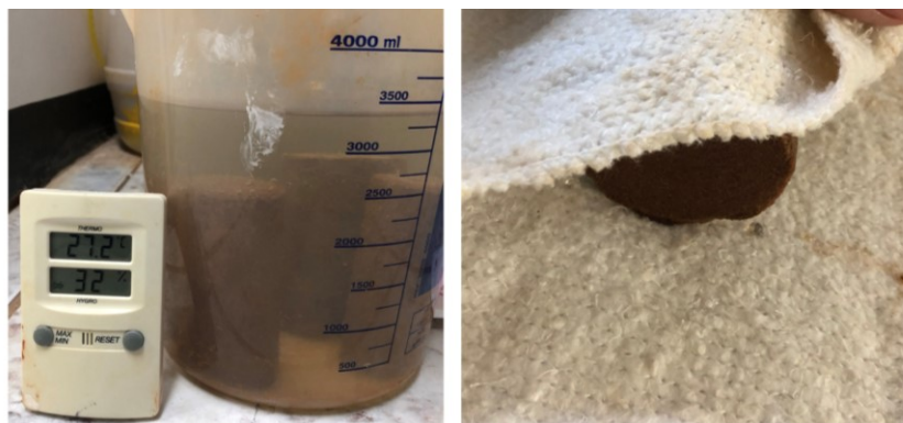
Figura 3.22. Método para determinação da absorção de água dos compósitos.
