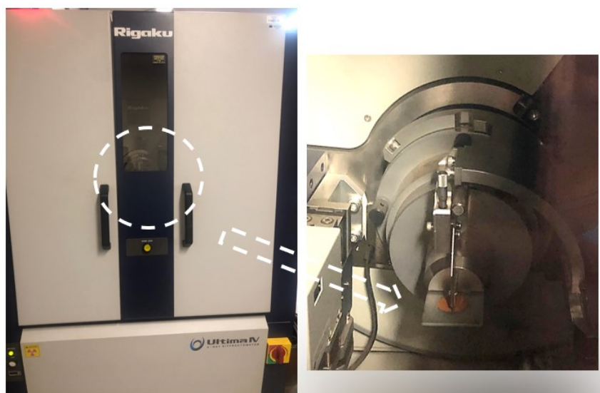
Figura 3.24. Difratorômetro de raios-X, sendo indicada amostra de rejeito em pó.
