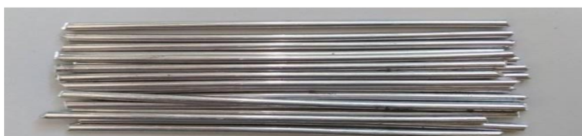
Figura 3.10 – Espécimes utilizados nos ensaios de fadiga por fretting
