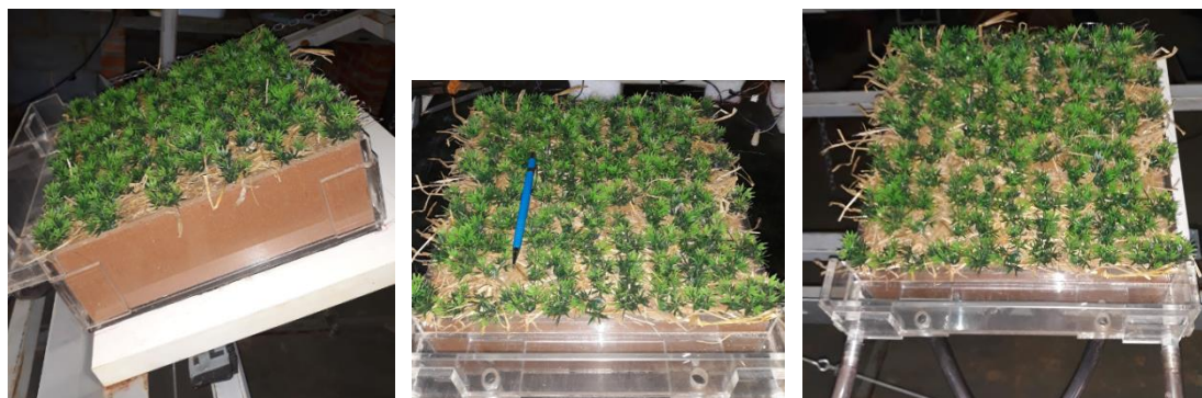
Figura 3.60 - Instalação da vegetação artificial na Geomanta 5 – Densidade 3
