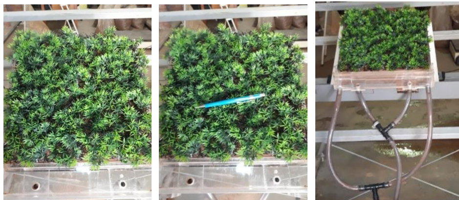
Figura 3.54 - Instalação da vegetação artificial na Geomanta 3 – Densidade 3
