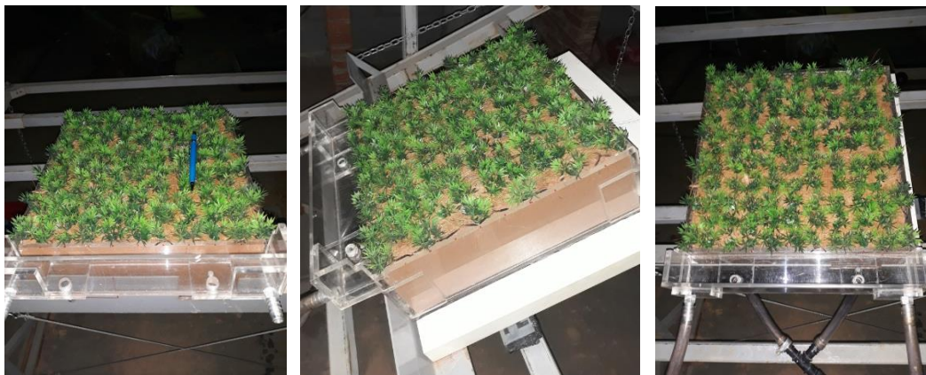
Figura 3.57 - Instalação da vegetação artificial na Geomanta 2 – Densidade 3
