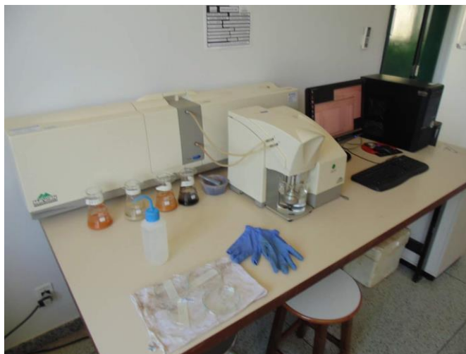
Figura 3.6 - Vista do equipamento Mastersizer 2000 - Malvern
