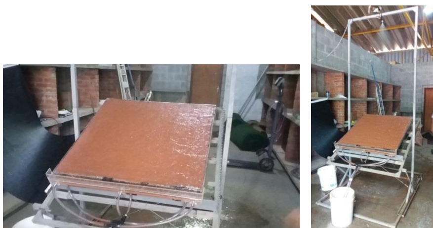
Figura 5.2 - Vistas da execução do ensaio de simulação de chuva na inclinação de 25°
