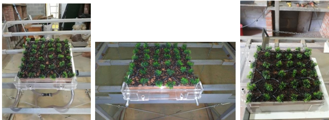
Figura 3.52 - Instalação da vegetação artificial na Geomanta 3 – Densidade 1
