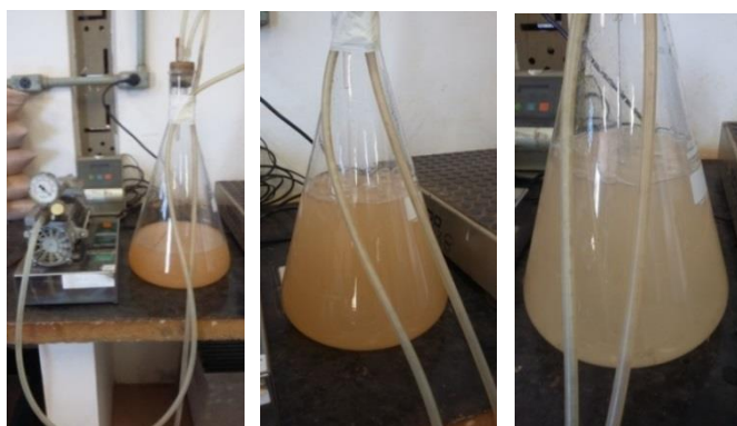
Figura 3.44 - Detalhes da bomba de vácuo para a retirada da água dos recipientes coletores
