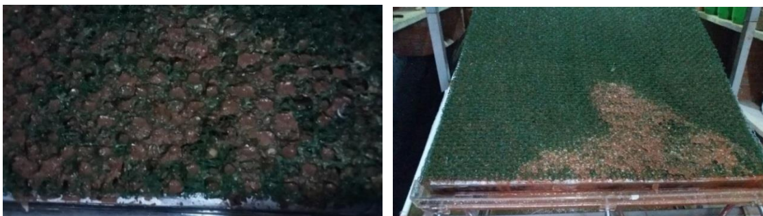
Figura 5.4 - Detalhe do fluxo gerado entre a Geomanta 1 e o solo durante o ensaio
