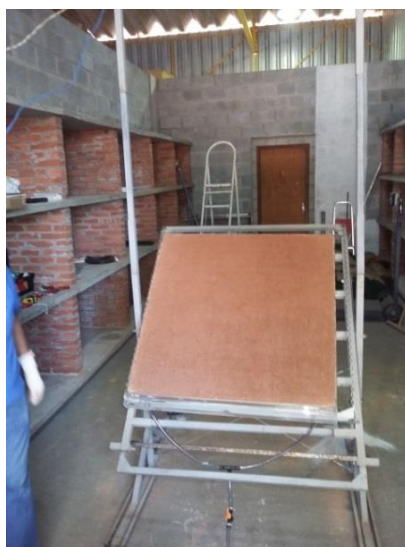
Figura 3.9 - Vista geral do simulador portátil de chuva por aspersão
