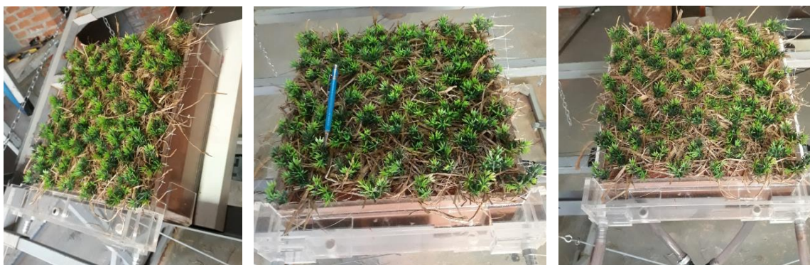
Figura 3.59 - Instalação da vegetação artificial na Geomanta 5 – Densidade 2
