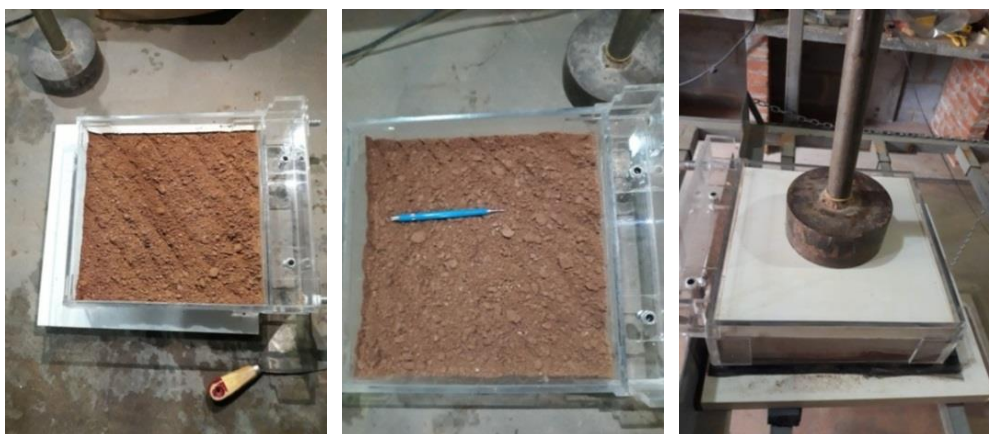
Figura 3.46 - Detalhe das ranhuras entre as camadas e da compactação
