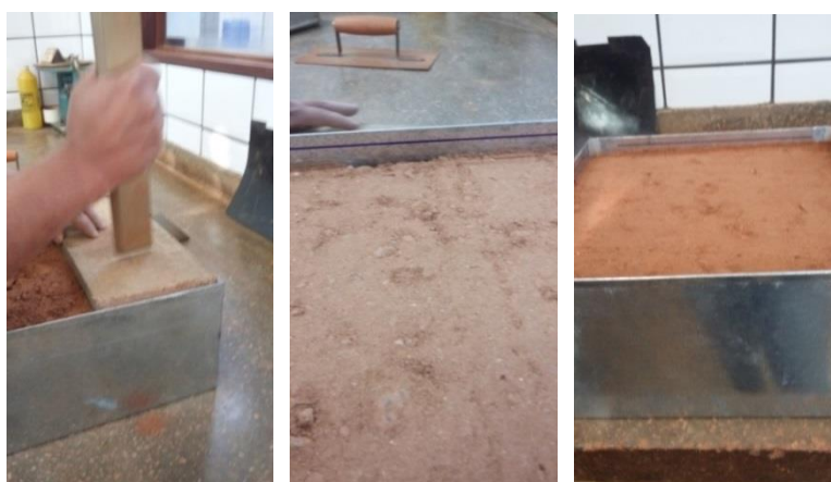
Figura 3.1 - Compactação da segunda camada de solo e detalhe da diferença de altura
