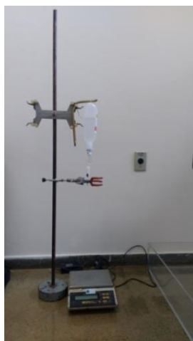
Figura 3.18 - Determinação da massa da água da gota pelas agulhas hipodérmicas
