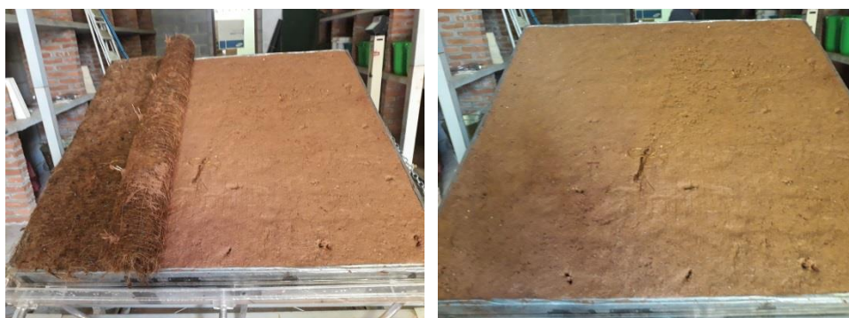
Figura 5.9 - Detalhe da superfície do solo após o ensaio com a Geomanta 4
