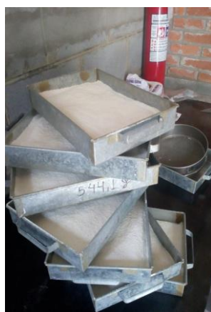
Figura 3.20 - Bandejas preparadas para determinação do diâmetro da gota e do grânulo
