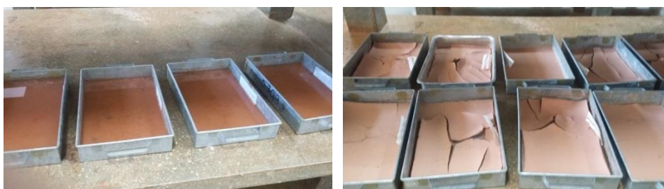
Figura 3.45 - Detalhes dos sedimentos antes e depois da estufa
