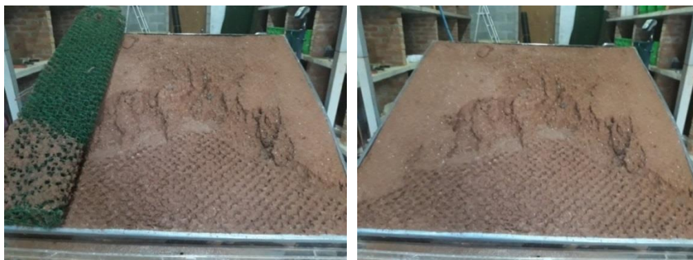
Figura 5.6 - Detalhe dos sulcos no solo após o ensaio com a Geomanta 1 fixada com 25 grampos
