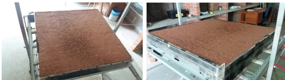
Figura 5.3 - Condição do solo após o ensaio de simulação de chuva – ensaio controle, inclinação de 25°
