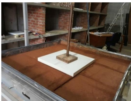
Figura 3.39 - Compactação do solo com a utilização da placa de madeira abaixo do soquete
