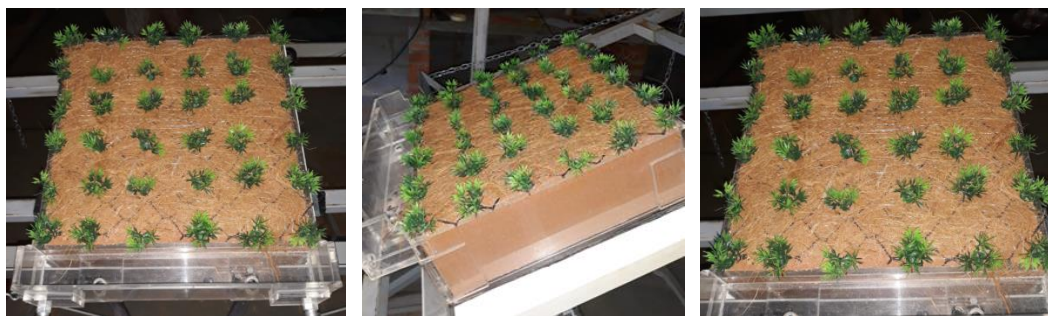
Figura 3.55 - Instalação da vegetação artificial na Geomanta 2 – Densidade 1
