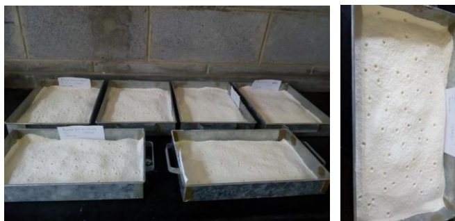
Figura 3.21 - Bandejas com os grânulos formados pelo gotejamento com as agulhas hipodérmicas
