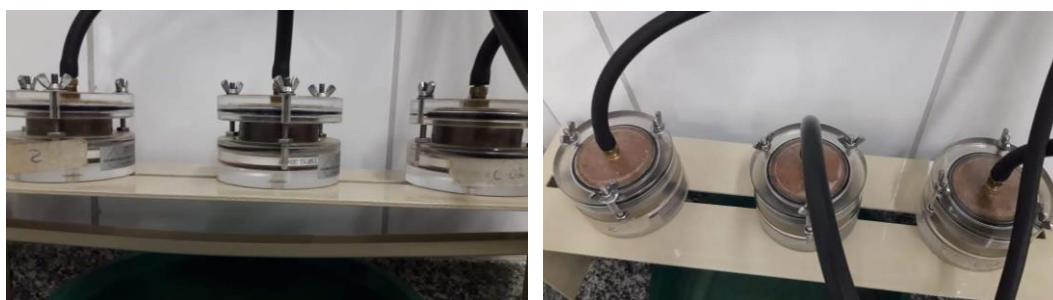
Figura 3.4 - Vista das amostras para o ensaio de curva característica do solo
