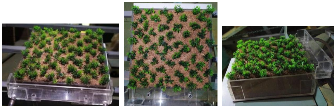
Figura 3.56 - Instalação da vegetação artificial na Geomanta 2 – Densidade 2
