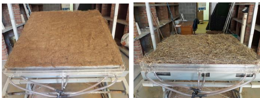
Figura 3.42 - Detalhe da instalação das geomantas na superfície do solo (Geomantas 4 e 5)
