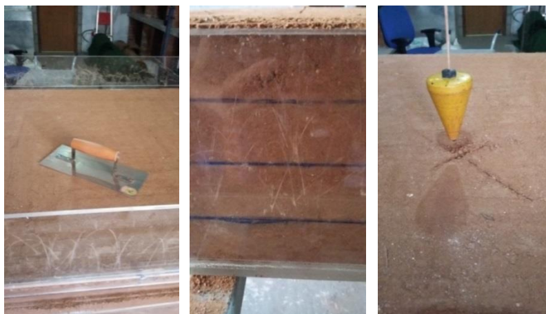
Figura 3.35 - Vista do solo compactado na caixa acrílica e a verificação do prumo e centro
