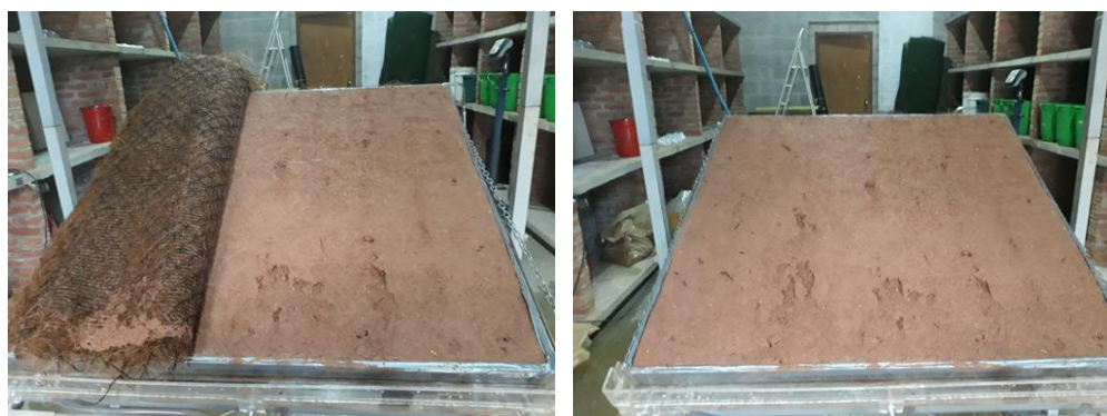
Figura 5.7 - Detalhe da superfície do solo após o ensaio com a Geomanta 2
