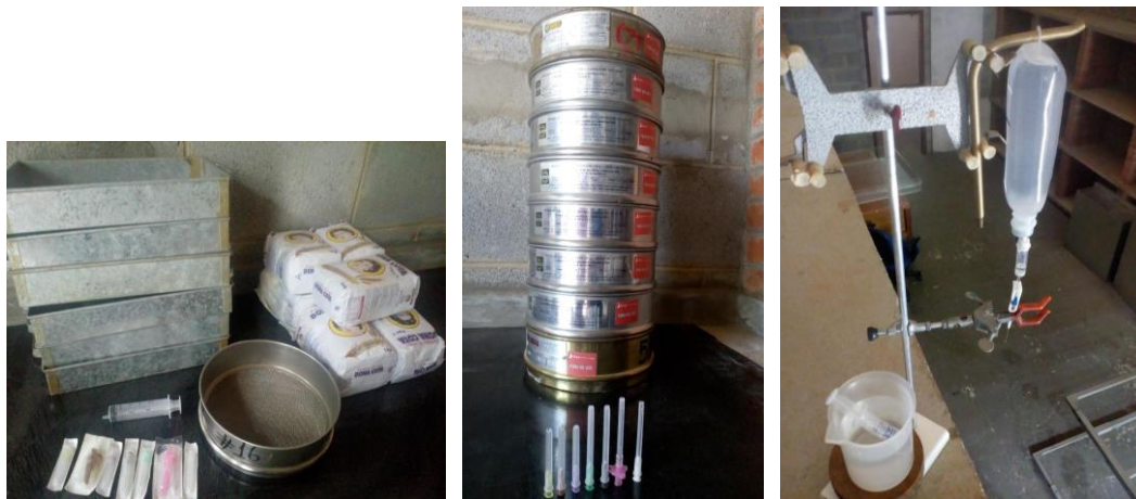
Figura 3.19 - Vista geral dos materiais utilizados para determinação dos grânulos utilizando as agulhas hipodérmicas
