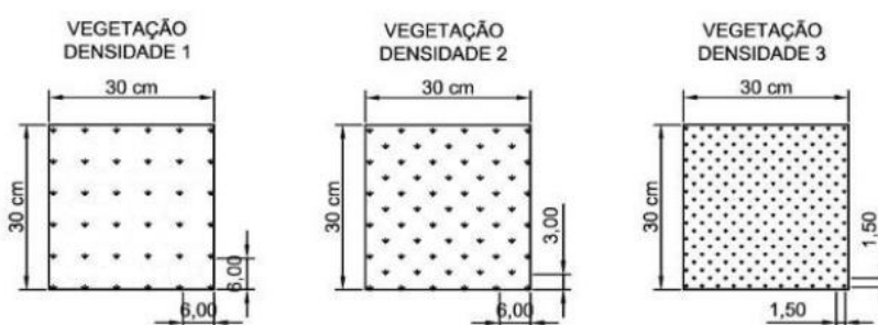
Figura 5.21 - Densidade da vegetação artificial instalada nas geomantas e no solo nu
