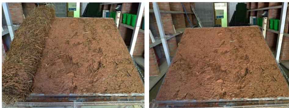
Figura 5.10 - Detalhe da superfície do solo após o ensaio com a Geomanta 5
