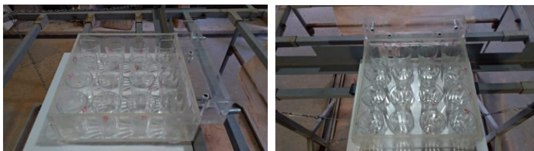
Figura 3.33 - Detalhes da preparação do ensaio para determinação do CUC
