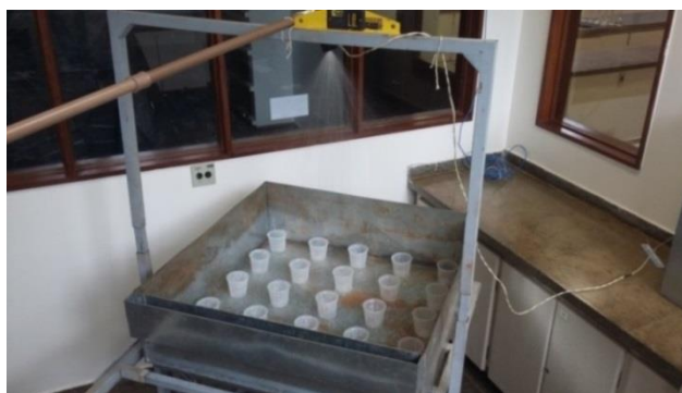
Figura 3.16 - Vista geral da caixa metálica e os copos para o ensaio de uniformidade
