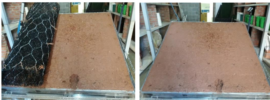
Figura 5.8 - Detalhe da superfície do solo após o ensaio com a Geomanta 3
