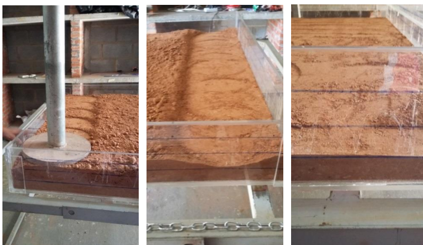
Figura 3.34 - Vista geral do solo sendo compactado na caixa acrílica
