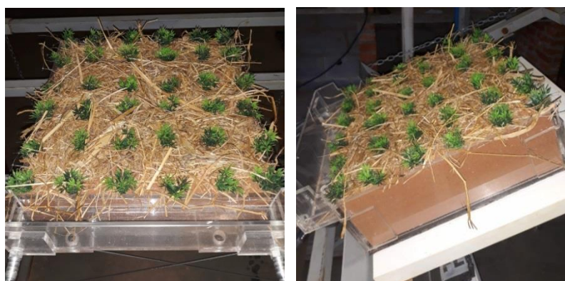
Figura 3.58 - Instalação da vegetação artificial na Geomanta 5 – Densidade 1
