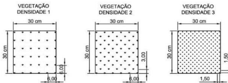
Figura 3.48 - Densidade da vegetação artificial instalada nas geomantas e no solo nu
