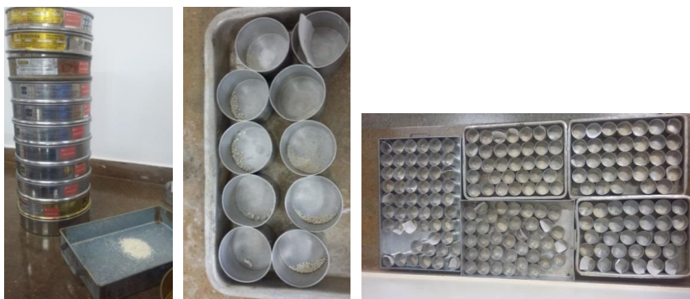
Figura 3.26 - Detalhe do peneiramento dos grânulos formados pela farinha
