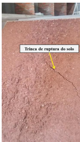
Figura 5.1 - Detalhe da ruptura do solo durante ensaio de simulação de chuva – inclinação 45°
