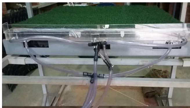
Figura 3.36 - Detalhe do aumento da calha e do número de orifícios para escoamento
