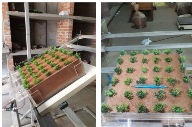
Figura 3.49 - Instalação da vegetação artificial no solo descoberto – Densidade 1
