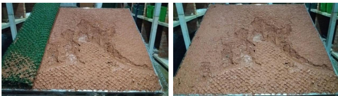
Figura 5.5 - Detalhe dos sulcos no solo após o ensaio com a Geomanta 1 fixada com 9 grampos
