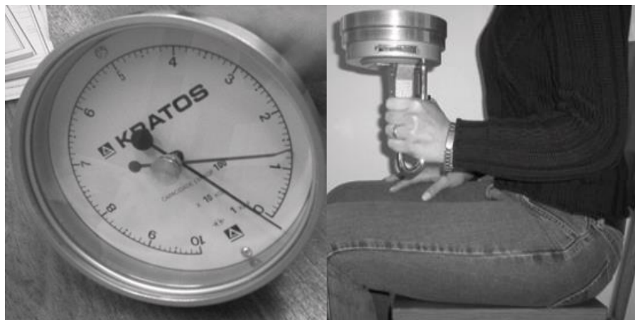
Figura 8 – Dinamômetro (à esquerda) e representação da posição do idoso para mensuração da força de prensão manual (à direita). Fonte: Pavan et al., 2006(127).
