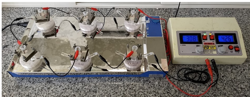
Figura 10: Esquema ilustrativo da aplicação de iontoforese em experimentos com células de difusão. As células são conectadas em série – com ânodos em vermelho e cátodos em preto – formando um circuito, em que os ânodos são alocados no compartimento doador e os cátodos, no receptor. Suportes são utilizados para que os eletrodos fiquem suspensos nas soluções, sem qualquer contato direto com peles ou membranas. Fonte: registros do autor.
