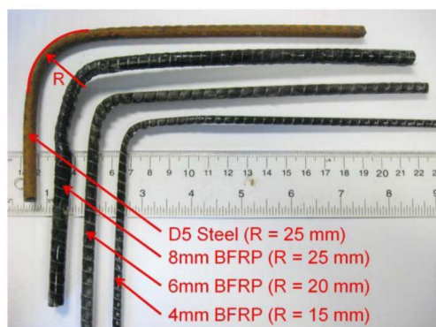
Figura 2.8: Conectores constituídos por barras dobradas de polímero reforçado com fibra de basalto (PRFB), conforme Tomlinson, Teixeira e Fam (2016).
