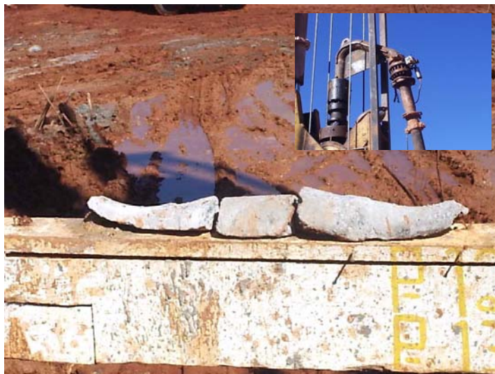
Figura 4.5 – Concreto retirado da curva de um equipamento perfuratriz
