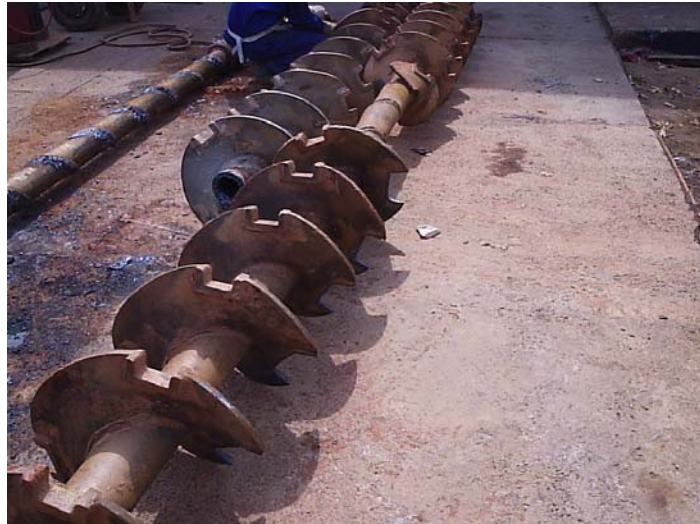
Figura 4.3 – Segmento de hélice danificado durante execução de estacas
