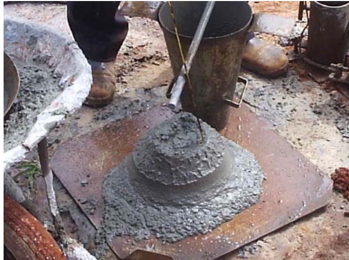
Figura 4.6 – Concreto com baixa trabalhabilidade; slump aproximadamente 17 cm
